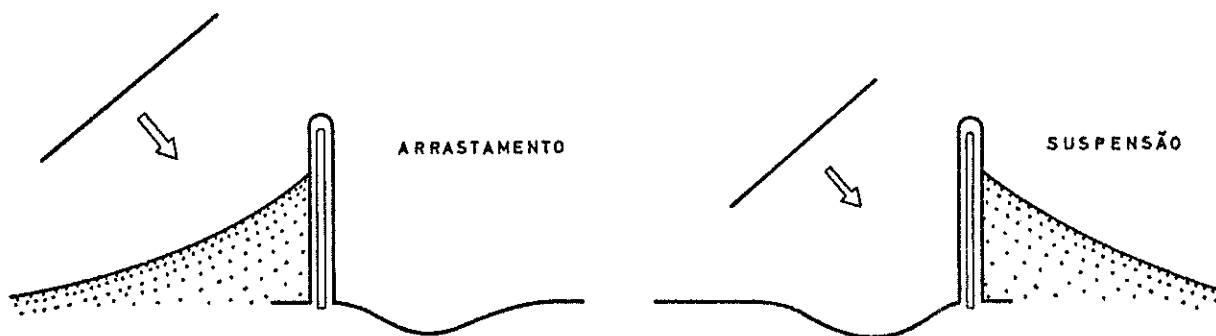
Fig.I.2 - Funcionamento hidráulico de esporões segundo Larras
