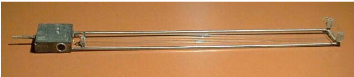
Fig. 5-4 - Aspecto de uma sonda resistiva utilizada nos ensaios
