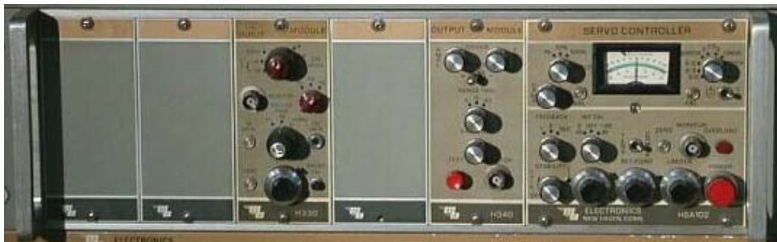
Fig. 6-25 - Painel de controlo do actuador do batedor
