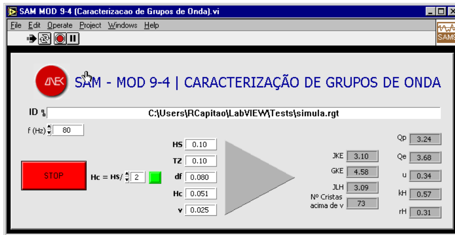
Fig. 3-7 - Exemplo de aplicação do programa SAM MOD 9-4 (Caracterização de Grupos de Onda)
