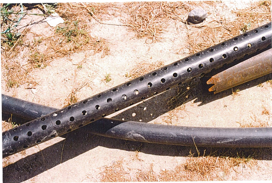
Foto 2 - Pormenor dos ralos da tubagem de um furo de injeção de água
