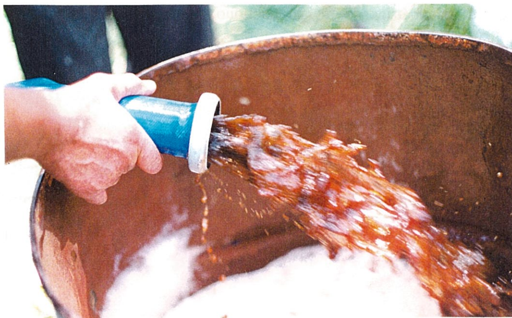
Foto 3 - Pormenor da extracção de água subterrânea num furo de monitorização
