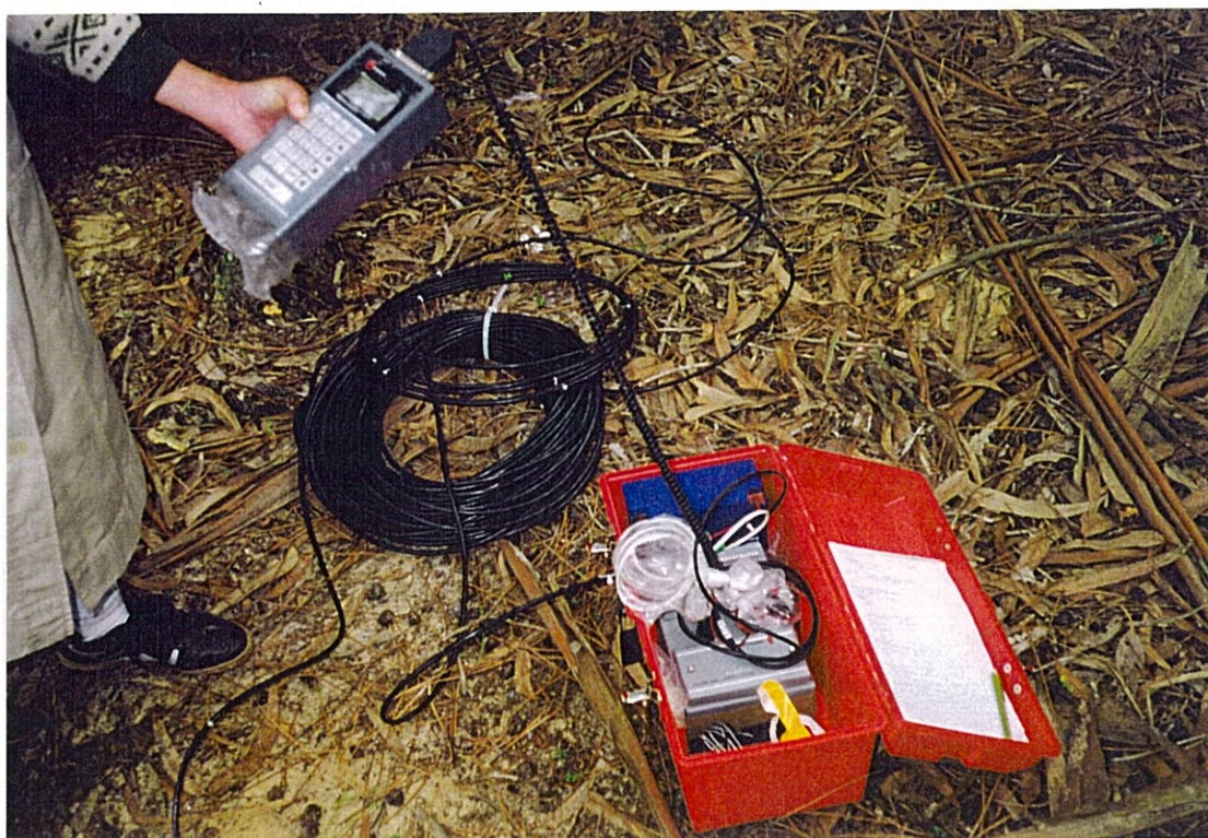
Foto 4 - Data logger utilizado para a monitorização em Estarreja
