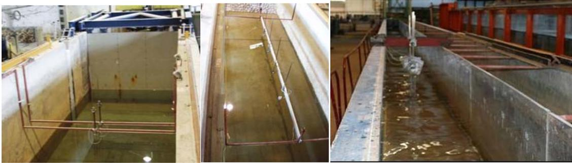
Figura 9 - Duas sondas junto ao batedor (esq.); Quatro sondas ao longo do canal (centro) – COI2; Seis sondas ao longo do canal – COI1 (dir.).
