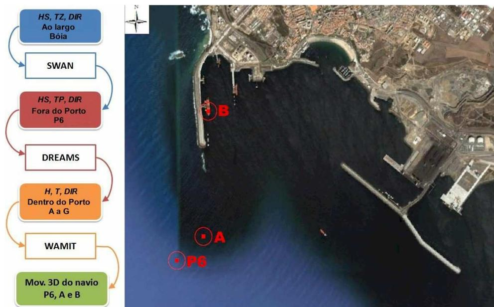
Figura 11 – Esquema de modelação para cálculo dos movimentos do navio e localização dos pontos onde foi aplicado o modelo WAMIT (imagem Google Earth™).
