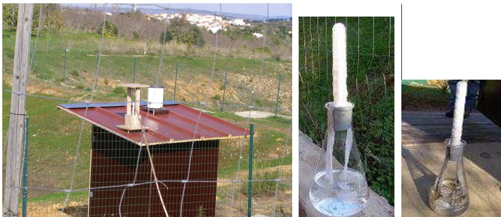
**Figura 9 – Sistema de Vela Húmida instalado no topo do abrigo. Pormenor do frasco de *Erlenmeyer* em duas situações: antes da colocação e no fim dos 63 dias de acumulação.**
