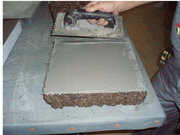
Fig. 6 – Execução de provetes de menores dimensões de um sistema
