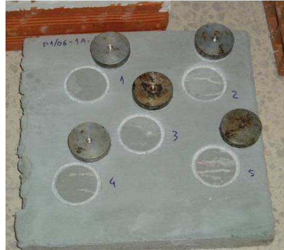
Fig. 12 – Ensaio de aderência da camada de base ao betão
