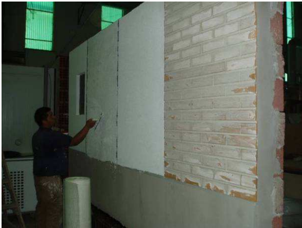
Fig. 5 – Murete com um sistema aplicado (que incluiu quatro acabamentos)
