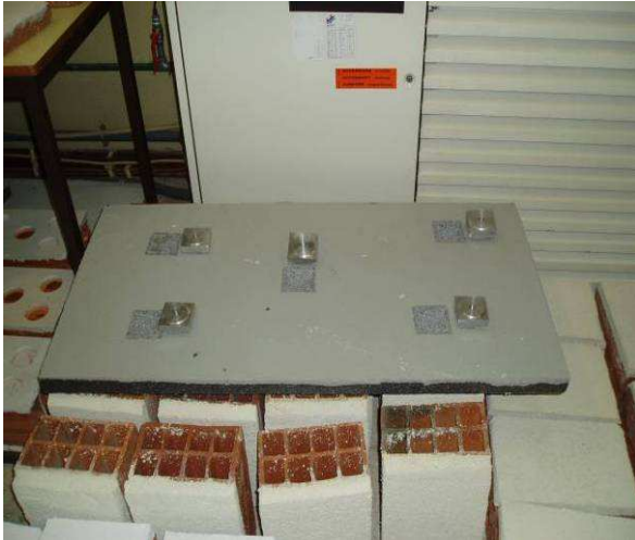
Fig. 11 – Ensaio de aderência da camada de base ao isolante
