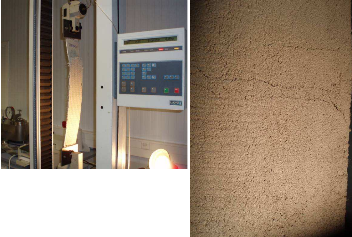
Fig. 14 – Ensaio de tracção da camada de base armada com rede de fibra de vidro (aspecto geral e pormenor da fendilhação resultante)
