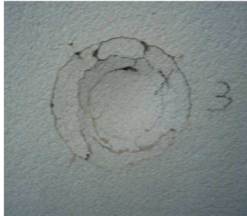
Fig. 8 – Sistema após ensaio de choque (com fendilhação mas sem penetração)
