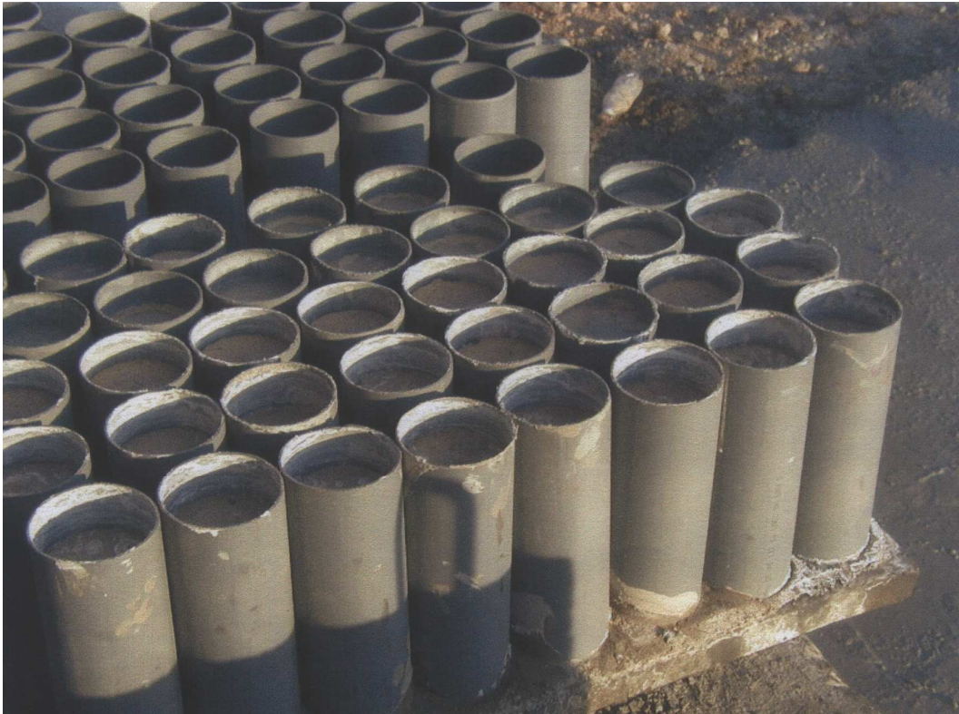
Foto 9 – Aspecto das amostras recolhidas na parede moldada auto-endurecedora, durante a escavação. (Dezembro de 2001).
