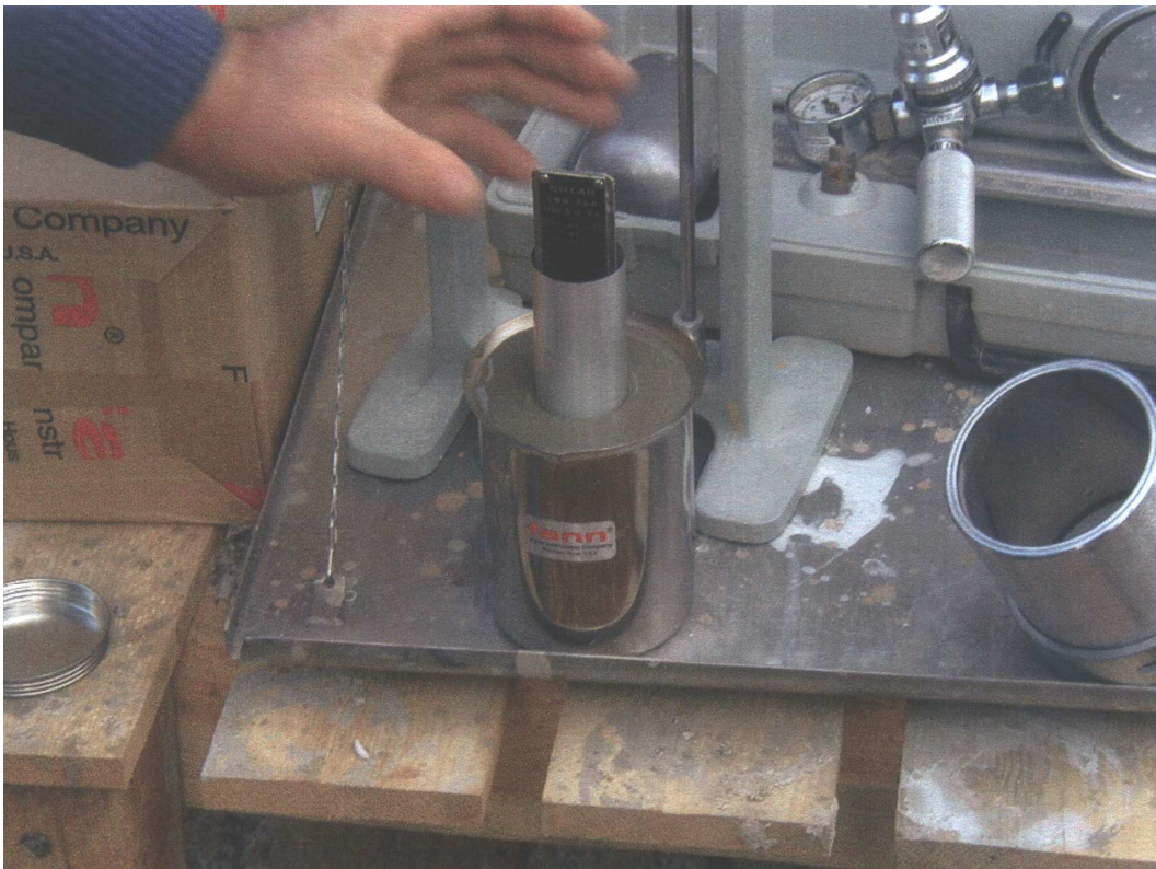
Foto 10 – Aparelho para medição da resistência do gel (“shearometer”).
