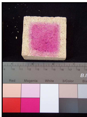
Figura 4.15 - Extensão de carbonatação ao fim de um mês de idade
