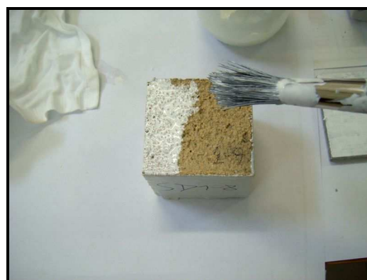
Figura 4.10 – Pormenor de aplicação dos revestimentos por pintura
