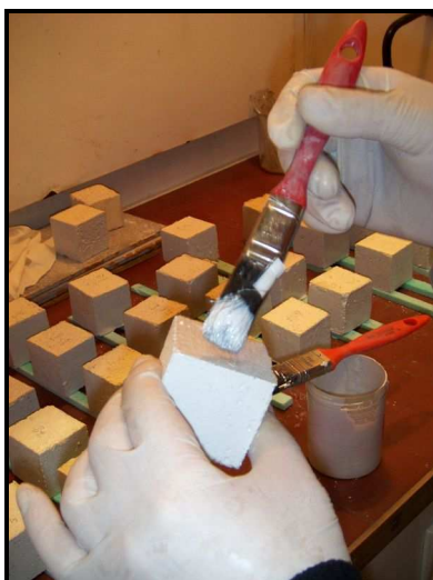
Figura 4.8 – Impermeabilização lateral dos provetes
