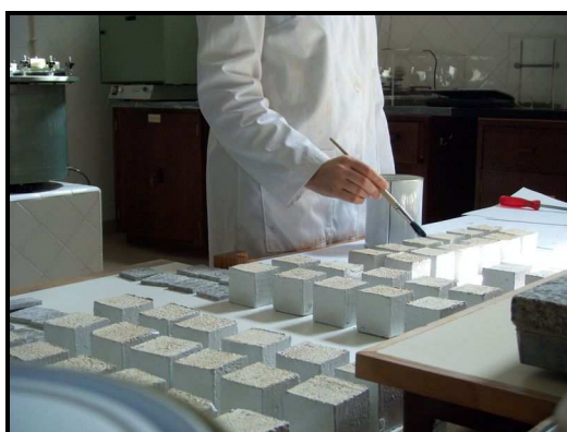
Figura 4.9 - Aplicação dos revestimentos por pintura
