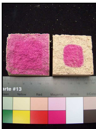
Figura 4.17 - Extensão da carbonatação ao fim de mês e meio de idade de amostras condicionadas em câmara climática (à esquerda) e sala condicionada (à direita)
