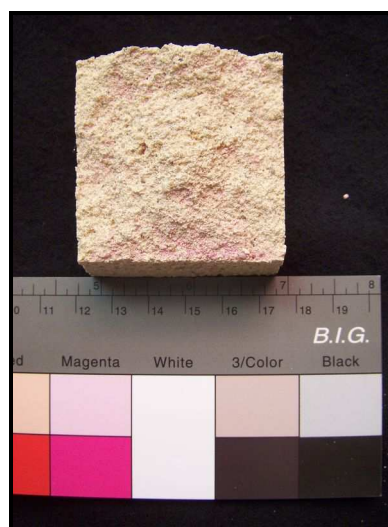
Figura 4.19 – Extensão da carbonatação após sujeição ao ambiente da câmara de carbonatação
