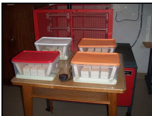
Figura 4.34 – Ensaio de absorção de água por capilaridade
