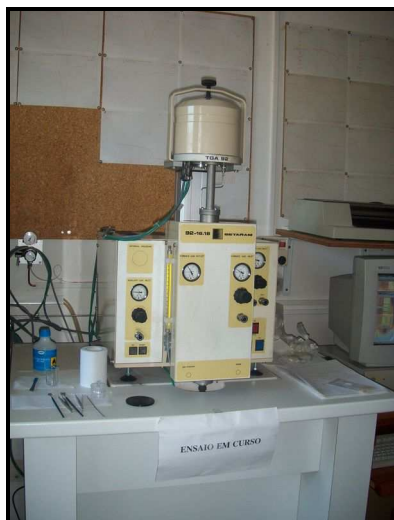
Figura 4.26 – Aparelho de análise termogravimétrica
