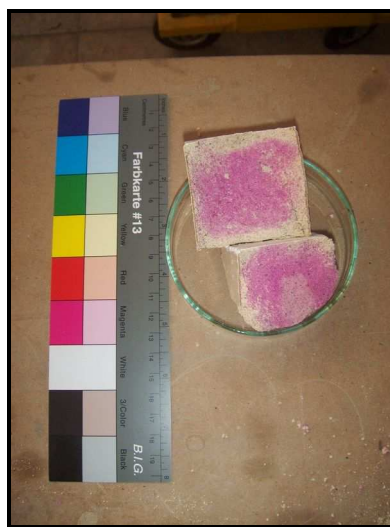
Figura 4.21 – Extensão da carbonatação após realização de ensaios de provete com comportamento divergente
