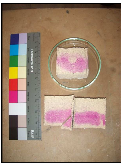
Figura 4.20 – Extensão da carbonatação após realização de ensaios de provete com comportamento consistente
