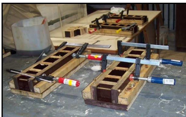
Figura 4.4- Moldes de madeira com grampos de carpinteiro
