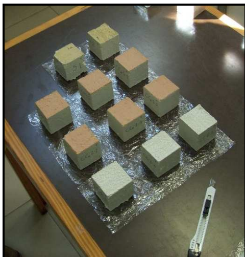
Figura 4.44 – Selagem da base dos provetes com folha de polietileno
