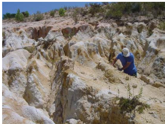
Fot. 4.6 - Barragem de Cadouços III (CIGB). Pormenor dos ravinamentos profundos reconhecidos no encontro direito (ELU 205) (COBA, 2001h).
