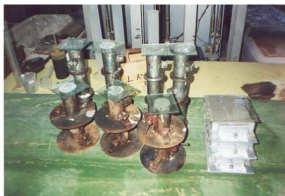
Figuras 7.65 e 7.66 – Moldagem e condicionamento dos provetes prismáticos (mesa vibratória e proteção com lâmina de vidro)
