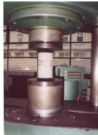
Figuras 7.63 e 7.64 – Ensaio de resistência à compressão
