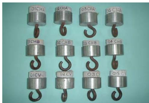
Figuras 7.81, 7.82, 7.83 e 7.84 – Ensaio de aderência ao suporte
