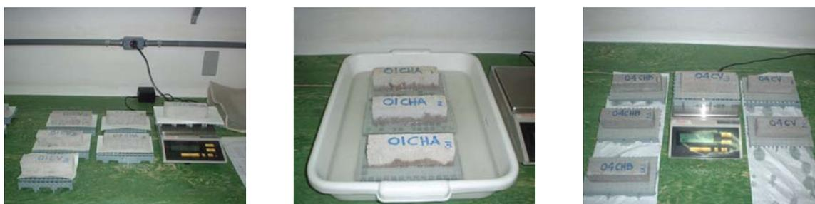
Figuras 7.53, 7.54 e 7.55 – Pesagem dos provetes secos, absorção por capilaridade e pesagem umedecida.
