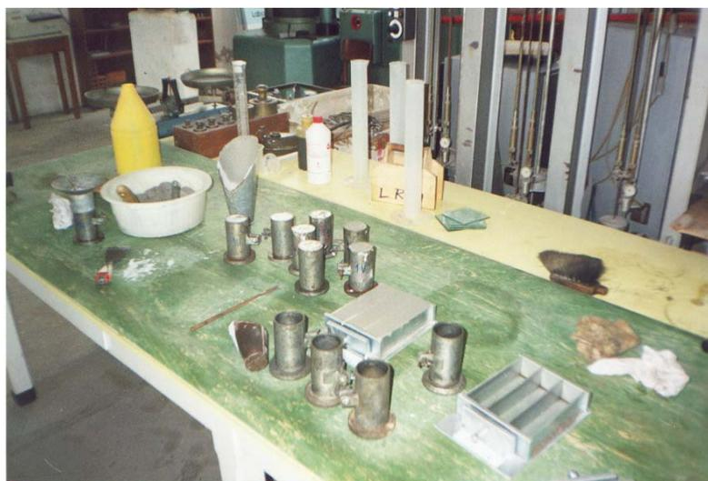
Figuras 7.58 e 7.59 – Moldagem dos provetes
