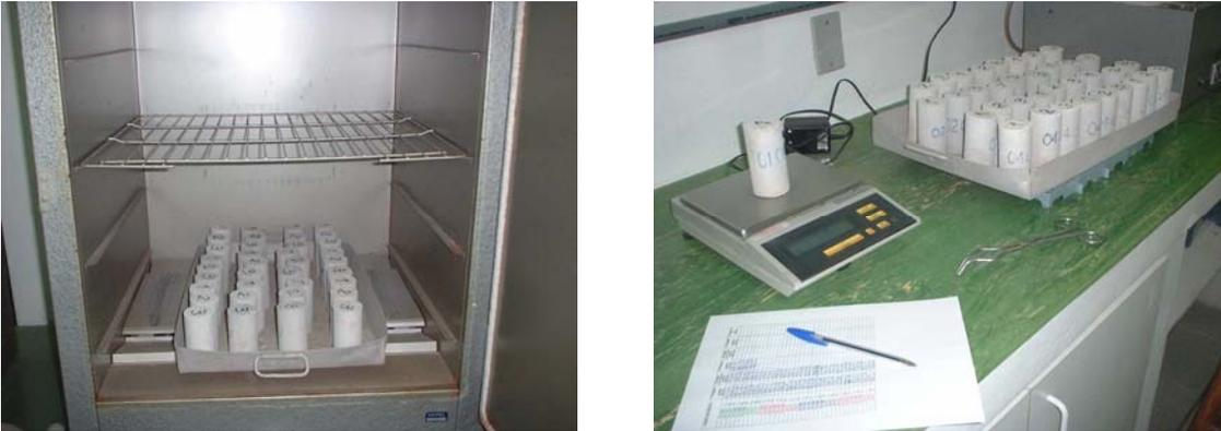
Figuras 7.56 e 7.57 – Secagem e pesagem dos provetes
