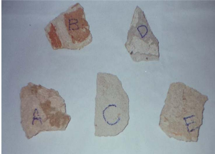
Figura 7.17 – Amostras de revestimentos para ensaios de absorção de água e reconstituição do traço
