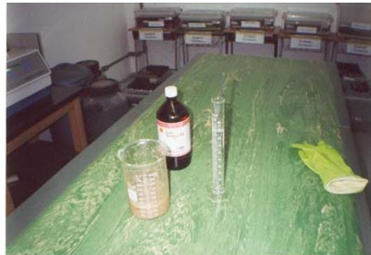
Figuras 7.20 e 7.21 – Secagem e imersão em ácido clorídrico
