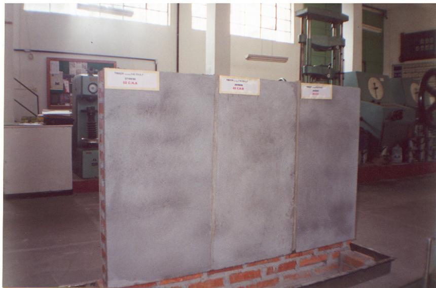
Figura 7.90 - Painel 1: Face Sul; possui como revestimento as argamassas alemãs 02CHA, 02CHB e 02CV.
