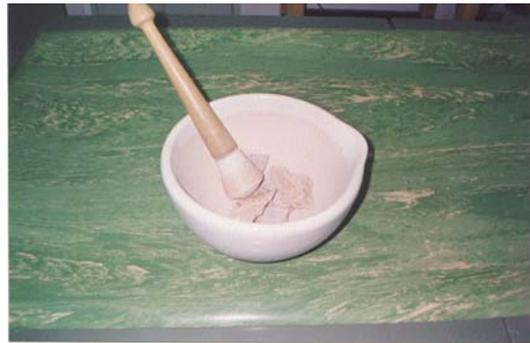
Figuras 7.18 e 7.19 – Pesagem e destorroamento
