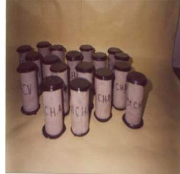
Figuras 7.60, 7.61 e 7.62 – Condicionamento termo-higrométrico, cura em cal e capeamento dos provetes
