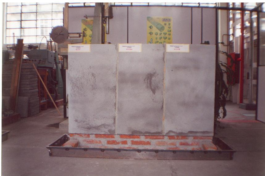
Figura 7.91 - Painel 2: Face Norte; possui como revestimento as argamassas 03CHA, 03CHB e 03CV (propostas).
