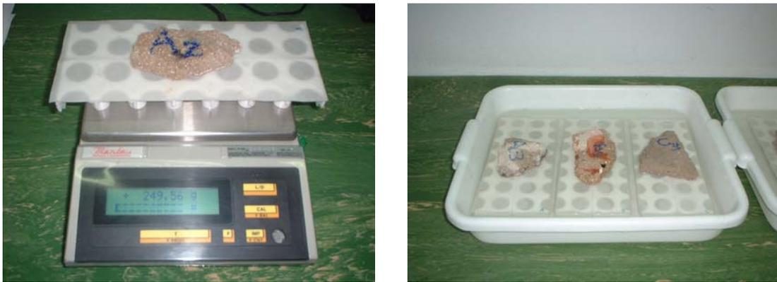
Figuras 7.44 e 7.45 – Pesagem e contato dos provetes com a água
