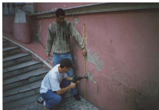
Figuras 7.13 e 7.14 – Extração de amostras dos revestimentos
