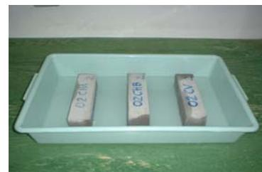
Figuras 7.72, 7.73 e 7.74 – Imersão parcial dos provetes em solução aquosa de sulfato de sódio a 5%
