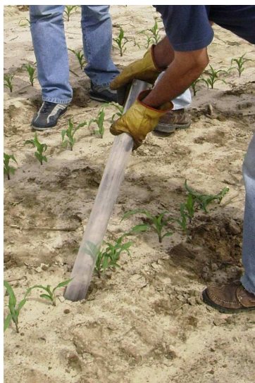
Fig. 4 - Tubo de acesso para minirizotróo e Endoscópio BTC Minirhizotron Camera Systems, Universidade de Évora
