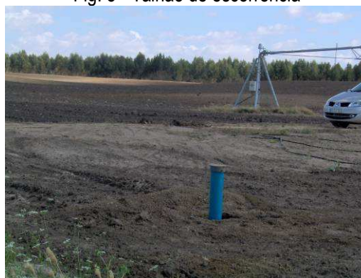
Fig. 7 - Piezómetro - águas subterrâneas
