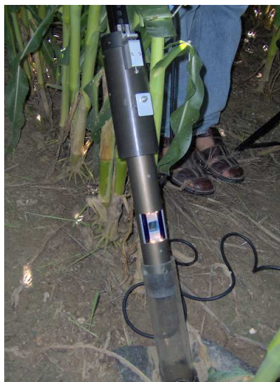
Fig. 4 - Tubo de acesso para minirizotróo e Endoscópio BTC Minirhizotron Camera Systems, Universidade de Évora
