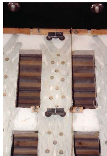
b) Vista dos reforços nos pisos 3 e 4
