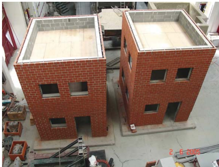
Figura 2.74 – Vista dos 2 modelos construídos [Degée et al. , 2007]
