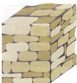
a) Montagem de blocos com junta desfasada
