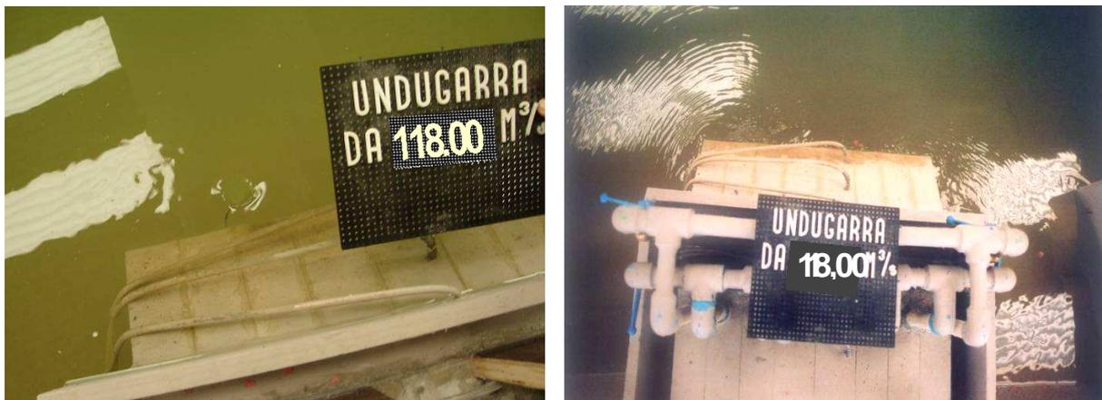
Figura 3 – Vista do escoamento à entrada dos sifões (fase de escoamento bifásico). Q = 118,0 m³/s (CMP)
