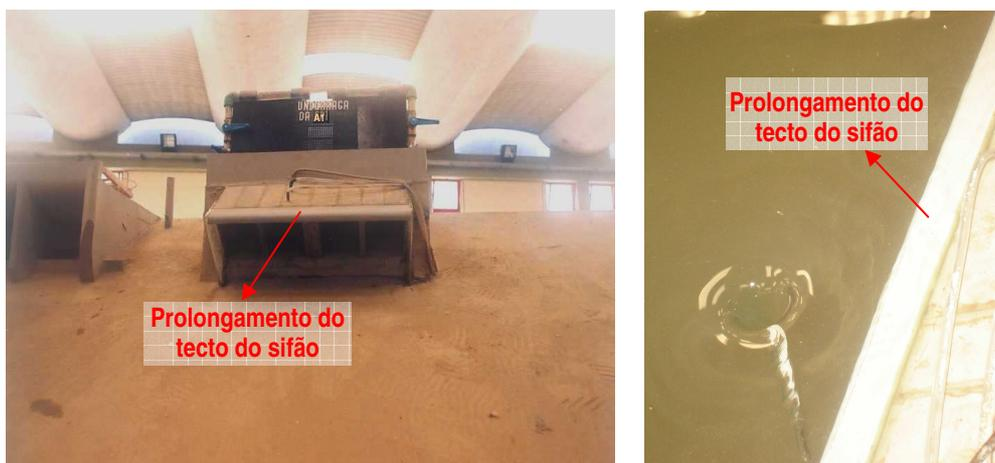
Figura 5 – Primeira modificação ensaiada. Prolongamento de 1 m do tecto do sifão.
