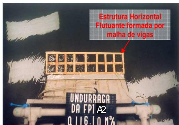
Figura 6 – Segunda modificação ensaiada. Adopção de uma estrutura malhada horizontal flutuante.
