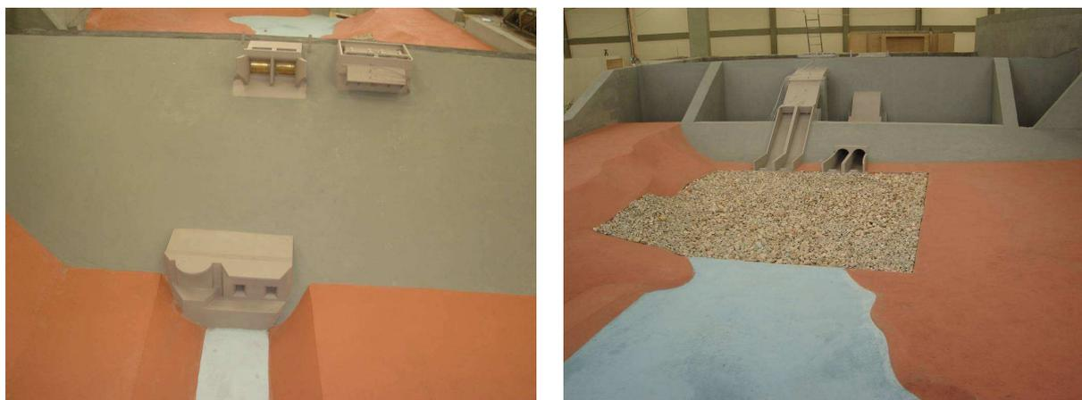
Figura 1 – Modelo físico da barragem de Undúrraga.
