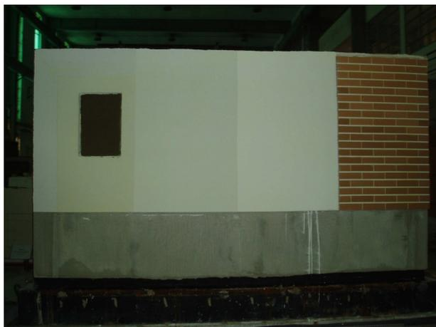
Fig. 5 – Vários acabamentos alternativos de ETICS (aplicação experimental no LNEC).
