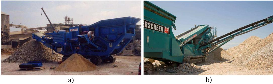
Figura 5 – Equipamentos de processamento: a) unidade móvel de reciclagem de RCD; b) crivagem de agregados reciclados
