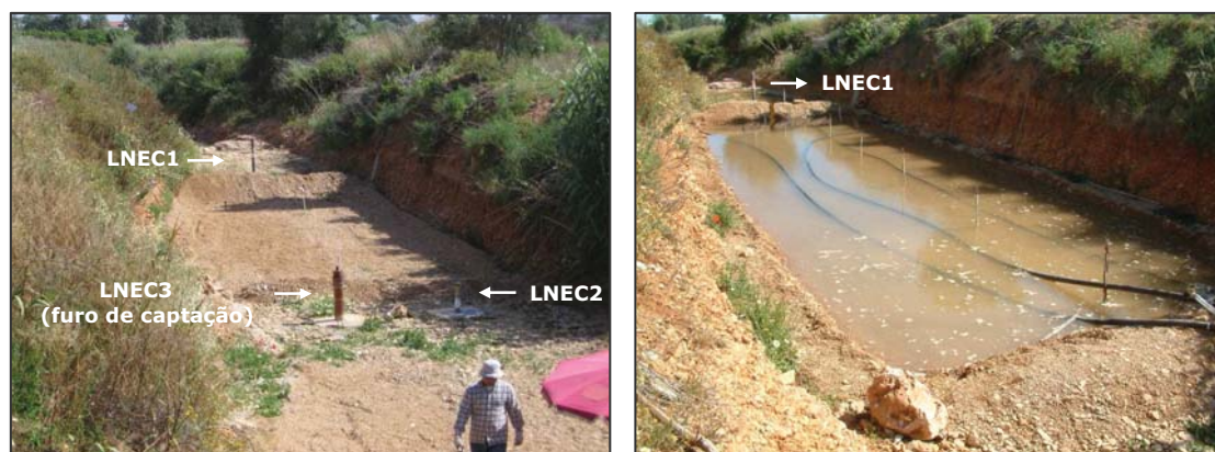
Figura 5.34 – Pormenor da bacia de infiltração (Sul) de Carreiros, antes e durante a realização do ensaio de infiltração
