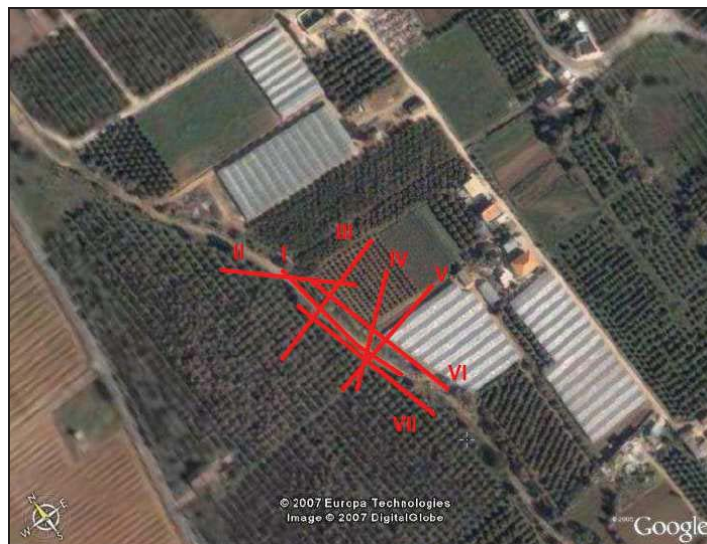
Figura 5.55 – Localização dos sete perfis de resistividade eléctrica realizados no caso de estudo de Carreiros (Mapa de base retirado do Google Earth ) (extraído de Mota, 2007)
