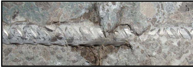
Figura 8.30 – Imagem da superfície duma réplica da liga SS2 na proximidade da fissura existente no betão C.
