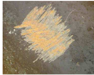
Fig. 4 - Patina preta lisa com subcamada laranja. a) Corte esquemático; b) Aspecto visual da patina preta e subcamada alaranjada
