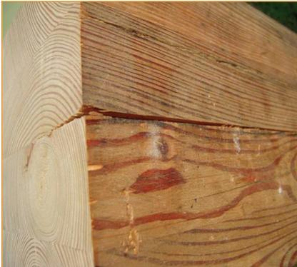
Figura 3: Delaminação da junta colada.
