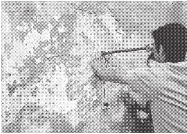
Fig. 7 – Ensaio de penetração controlada
