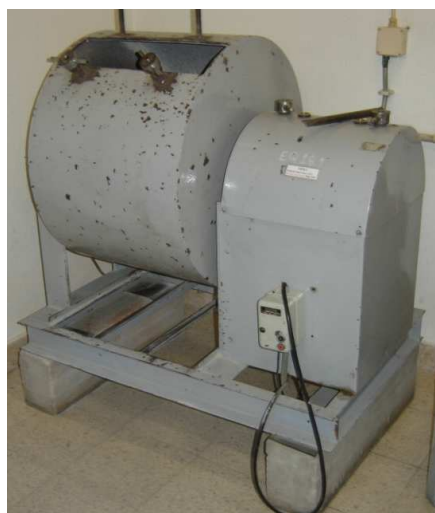
Figuras 3.1 e 3.2: Esferas de aço e equipamento rotativo utilizados no ensaio de determinação da resistência à fragmentação (método de Los Angeles).
