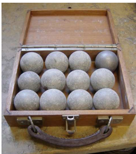
Figuras 3.1 e 3.2: Esferas de aço e equipamento rotativo utilizados no ensaio de determinação da resistência à fragmentação (método de Los Angeles).
