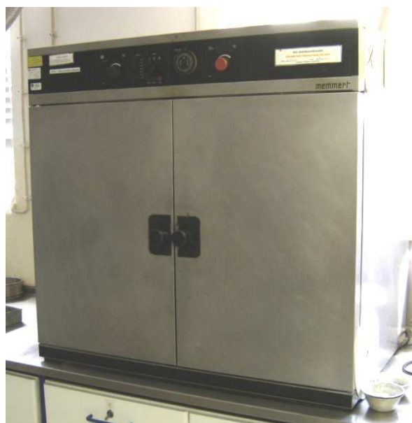
Figura 4.1: Estufa utilizada pelo LNEC/PAVMAT na secagem do provete de ensaio.
