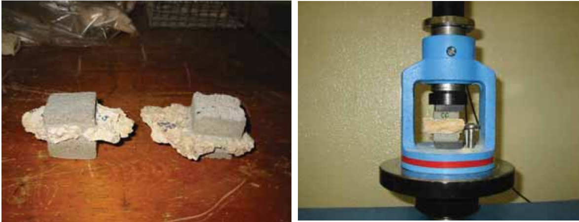
Fig. 27 – Ensaio de compressão de amostras de argamassas extraídas em obra
