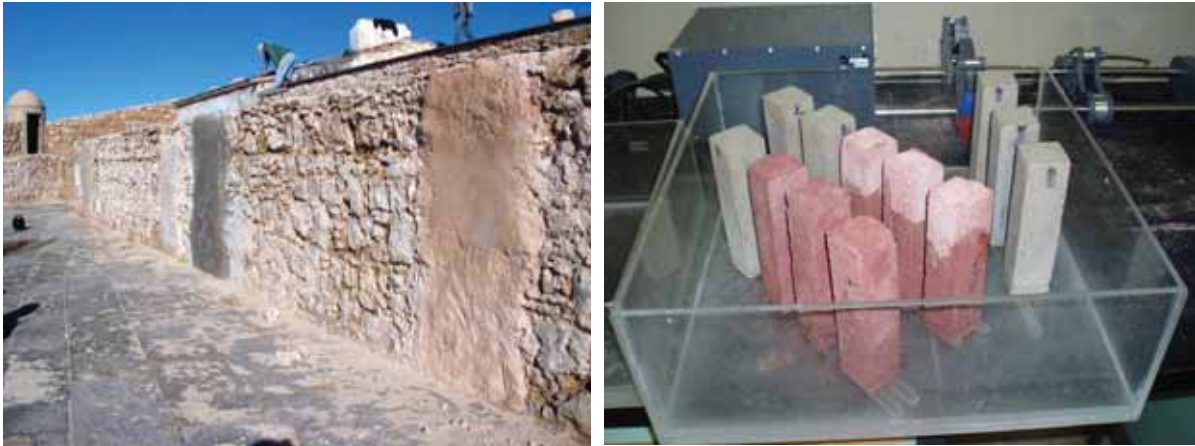
Fig. 44 – Aplicações experimentais e ensaios laboratoriais sobre argamassas de substituição com base em cal
