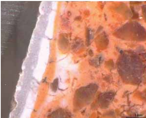
Fig. 25 – Observação de amostra estratigráfica à lupa binocular. Reboco e diversas camadas. Ampliação 15x
