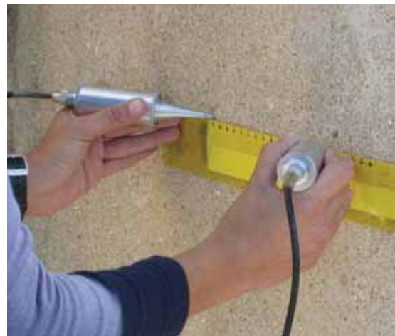
Fig. 32 – Realização de ensaio com ultra-sons
