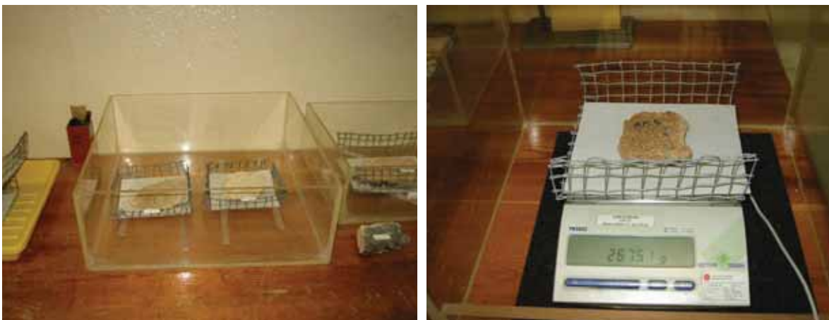
Fig. 28 – Ensaio de capilaridade de amostras de argamassas extraídas em obra
