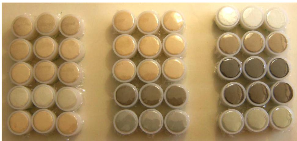
**Figura 5** – Cápsulas para ensaios *ex situ* (três réplicas para cada amostra).
