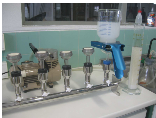
Figura 2 – Aspecto da filtração da amostra no sistema de filtração e filtro com amostra após secagem
