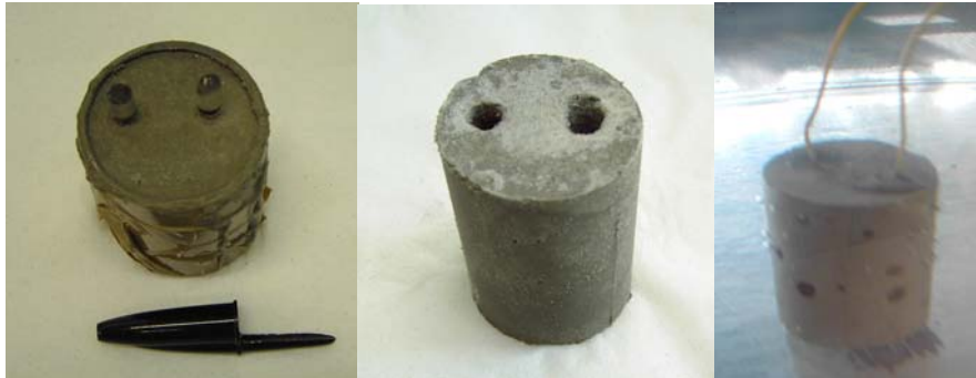
Figura 7 - Preparação dos sensores com eléctrodos de grafite em pó. À esquerda a fase inicial. Ao centro o provete curado. À direita o sensor concluído.
