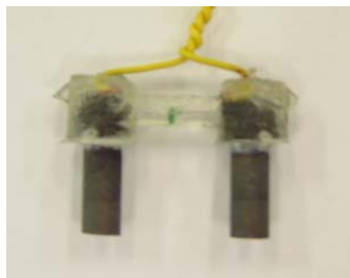
Figura 4 – Sensor de resistência eléctrica com eléctrodos de grafite “em varão”.
