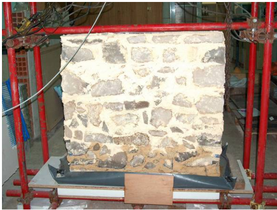
Fig. 6 – Aspecto da face não-rebocada da maqueta 2 de alvenaria durante a fase de imersão parcial
