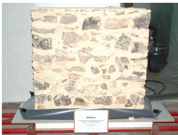
Fig. 4 – Maqueta 2 de alvenaria de pedra irregular (face não-rebocada)
