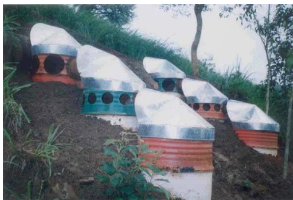
Figura 15 – Disposição dos colectores para recolha de escoamento e sedimentos (Lecka, 2004).
