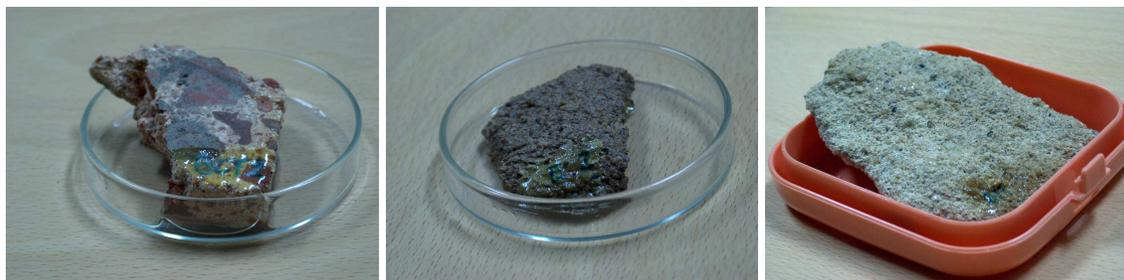
Fig. 25 – Amostras BCT, EMT e FOIT, respectivamente. Condensação à 95% de HR
