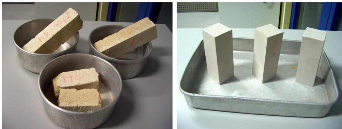
Fig. 3 – Argamassa com base em cal e pedra calcária
