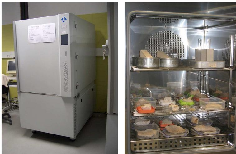
Fig. 5 – Câmara usada para o ensaio, amostras em ensaio no interior da câmara
