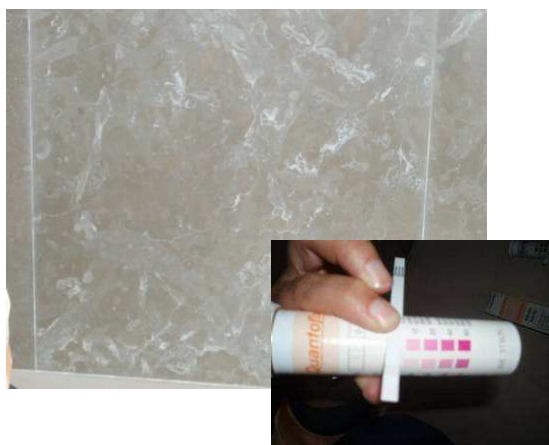
Fig. 2 – Identificação de sais em pedra natural (realizado “in situ”), com utilização de indicadores colorimétricos
