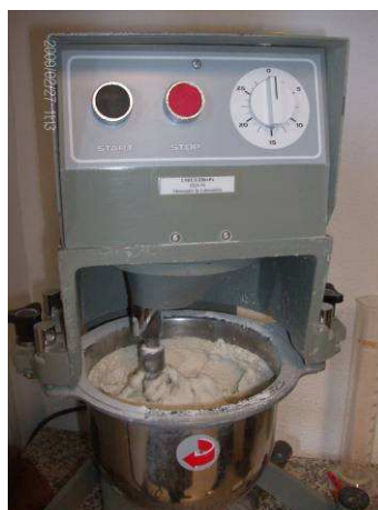
Fig. 3 – Ensaio realizado em laboratório para testar a adequabilidade ao uso do produto utilizado na colagem
