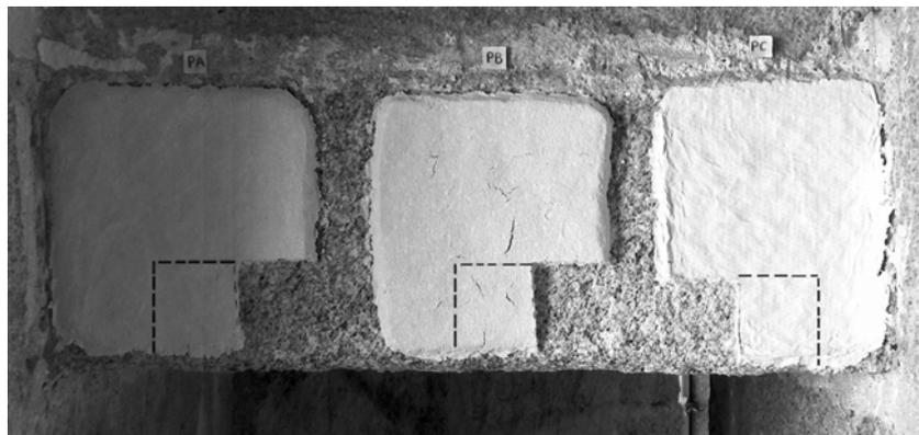
Fig. 7: Exemplo de amostragem periódica de diferentes compressas de dessalinização durante um ensaio experimental *in situ*
