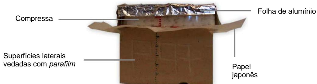
Fig. 3: Montagem do ensaio de absorção de água por capilaridade de provetes em contacto com compressas húmidas
