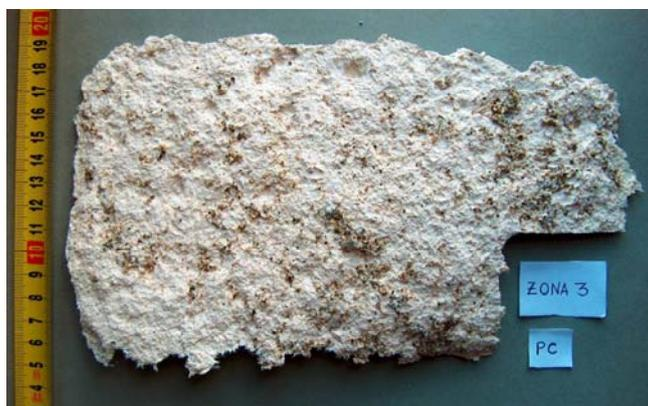
Fig. 10: Aspecto da superfície de uma compressa que esteve em contacto com o substrato salinizado após um ensaio de dessalinização *in situ* onde se pode observar que houve destacamento de alguns grãos e escamas de material pétreo
