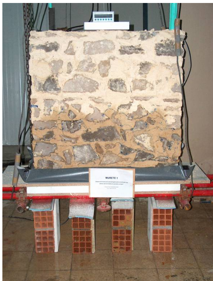
Fig. 7 – Aspecto da maqueta de alvenaria durante a fase de imersão parcial
