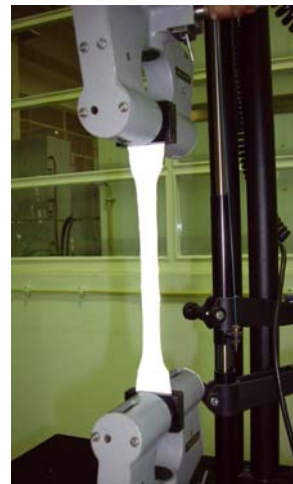
Figura 13: Ilustração de uma película de tinta a) antes do ensaio e b) alongamento máximo antes da rotura
