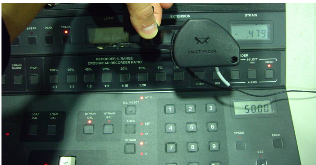
Figura A.1: Calibração do extensómetro estático de 50 mm de base de medida
