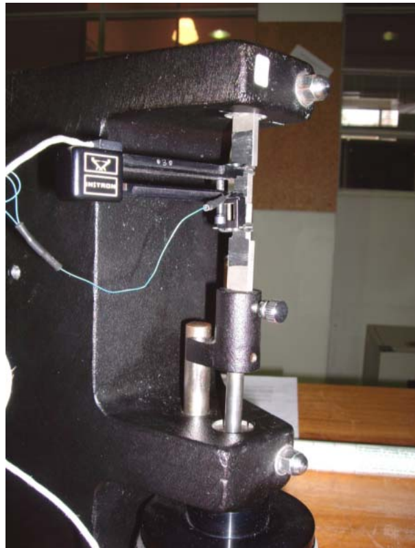
Figura A.2: Calibração do extensómetro dinâmico de 25 mm de base de medida, no micrómetro
