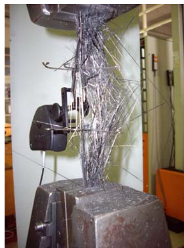
Figura 11: Ilustração de uma Fibra de carbono a) antes do ensaio e b) depois da rotura
