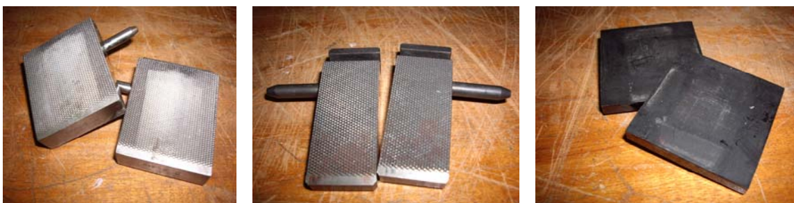
Figura 5: Tipos de mordentes existentes no NMO, para usar com: (a) recarquilhado para garras em cunha; (b) lisos para garras pneumáticas
