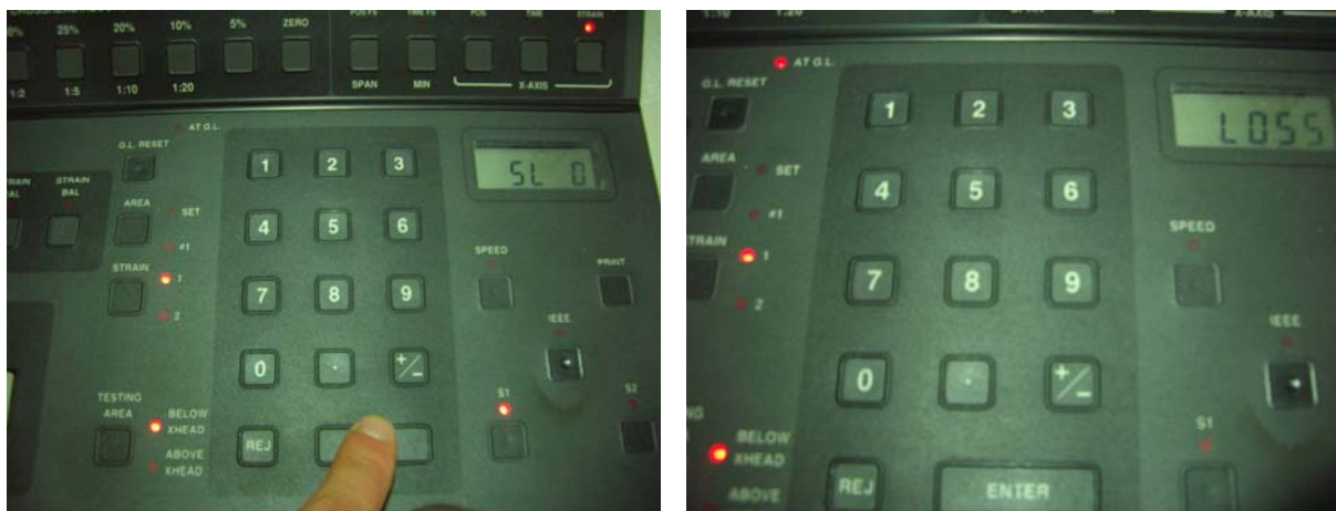
Figura A.3: Primeiro passo para a calibração do extensómetro
