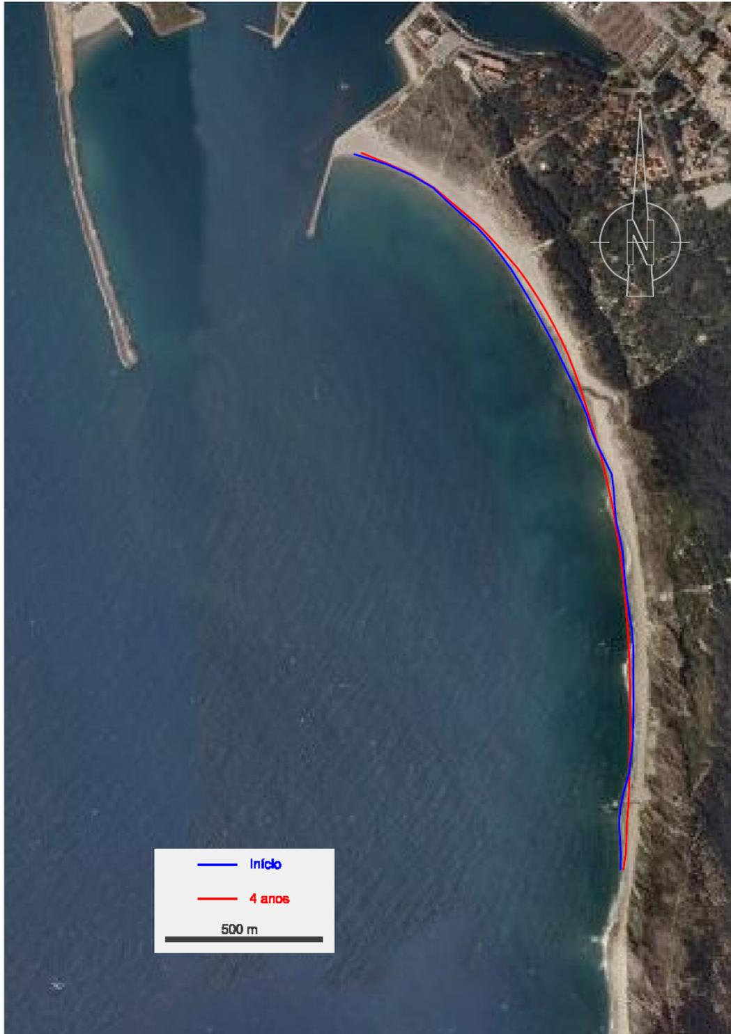
Fig. 12 – Simulação da estabilidade da linha de água da praia do Cabedelo (Viana do Castelo).
