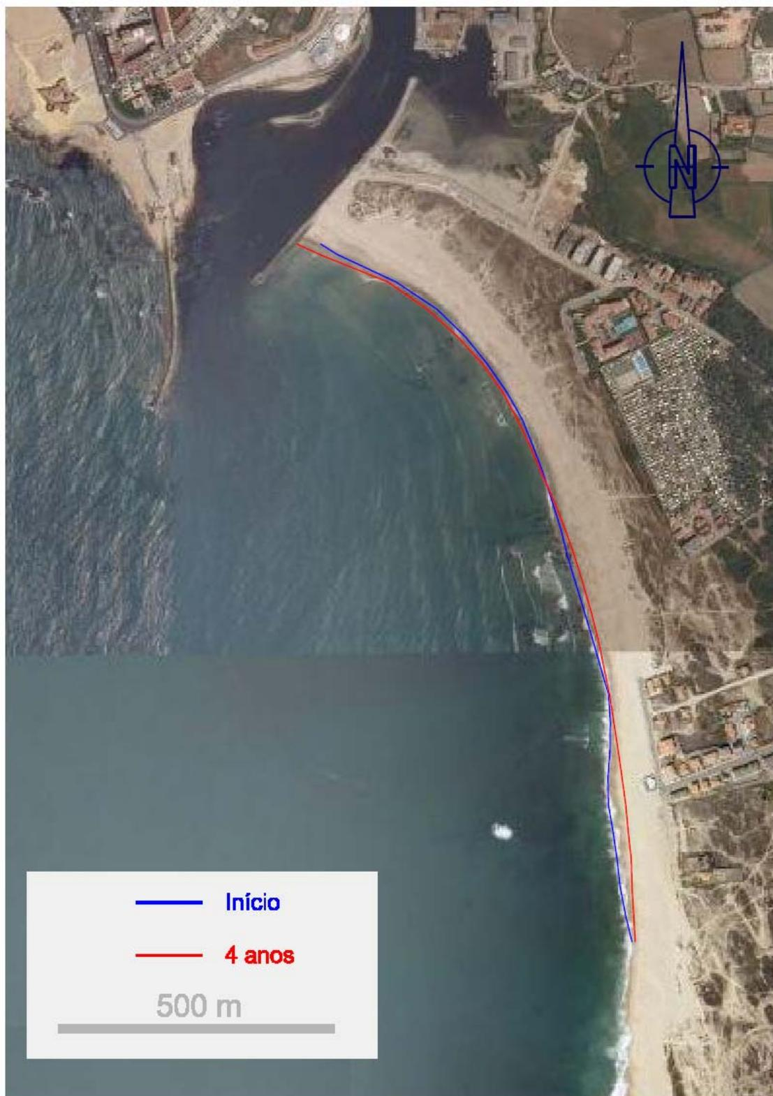
Fig. 14 – Simulação da estabilidade da linha de água da praia da Árvore (Vila do Conde).
