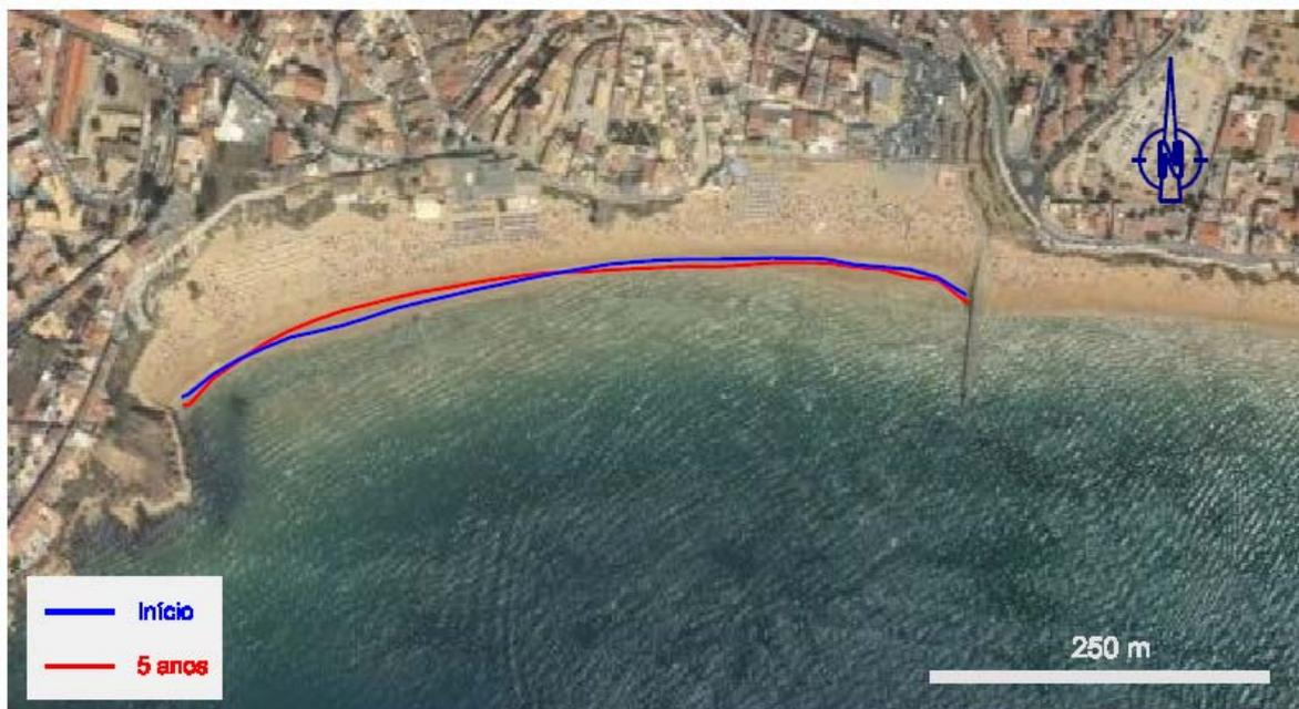
Fig. 5 – Simulação da estabilidade da linha de água da praia de Albufeira.
