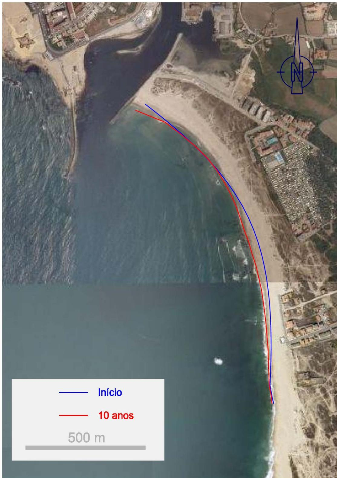
Fig. 15 – Simulação da linha de água de equilíbrio da praia da Árvore (Vila do Conde), a partir de uma configuração inicial rectificada.
