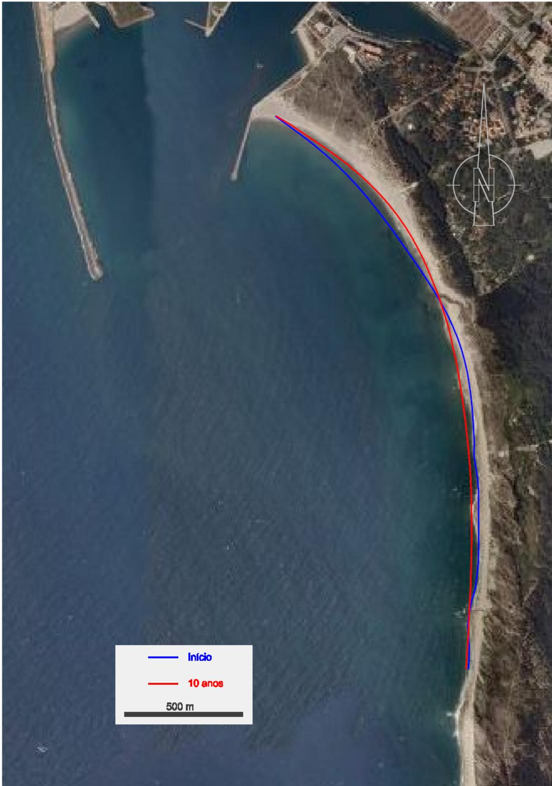
Fig. 13 – Simulação da linha de água de equilíbrio da praia do Cabedelo (Viana do Castelo), a partir de uma configuração inicial rectificada.
