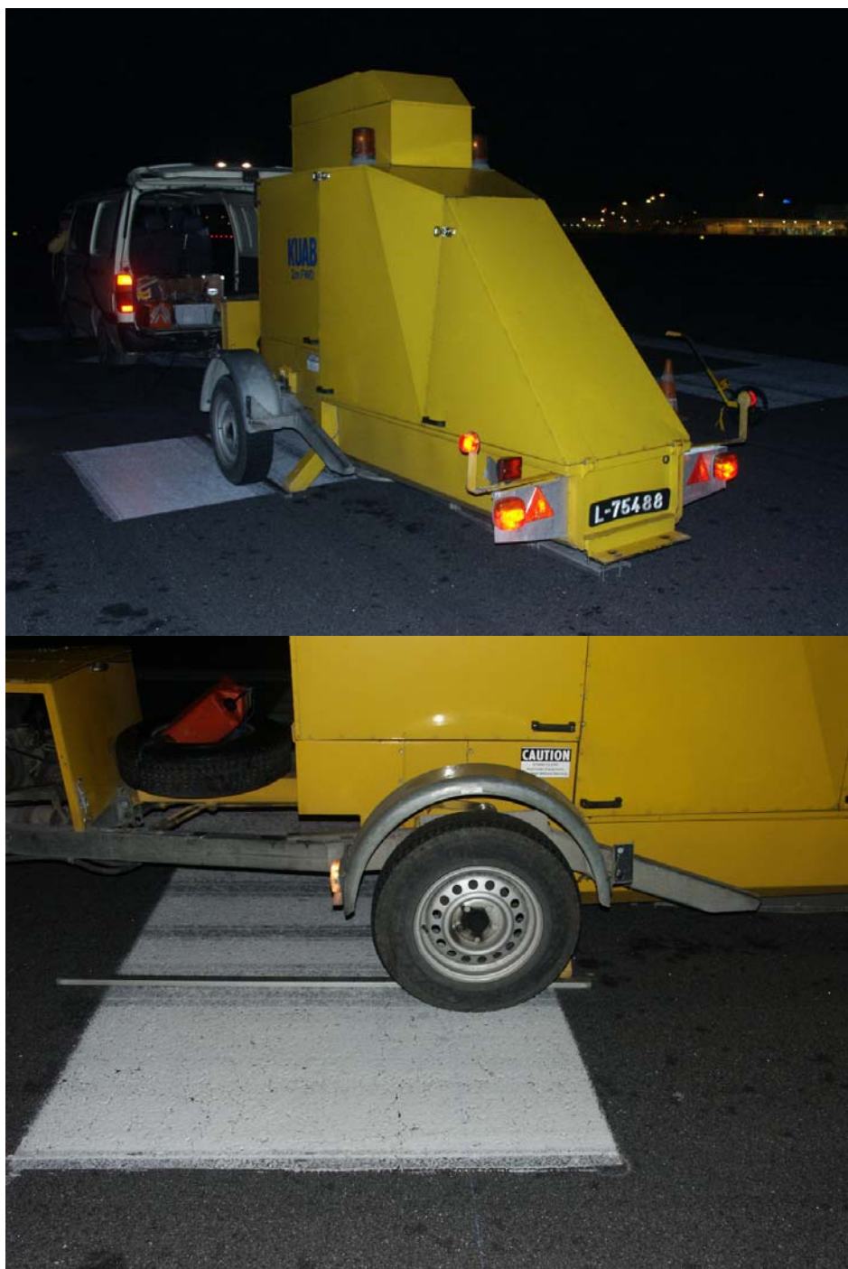
Figura 4.12 – Realização dos ensaios de carga nas juntas das lajes
