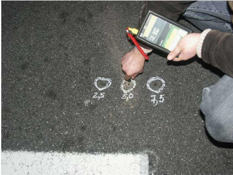
Figura 4.14 – Medição da temperatura das camadas betuminosas a várias profundidades
