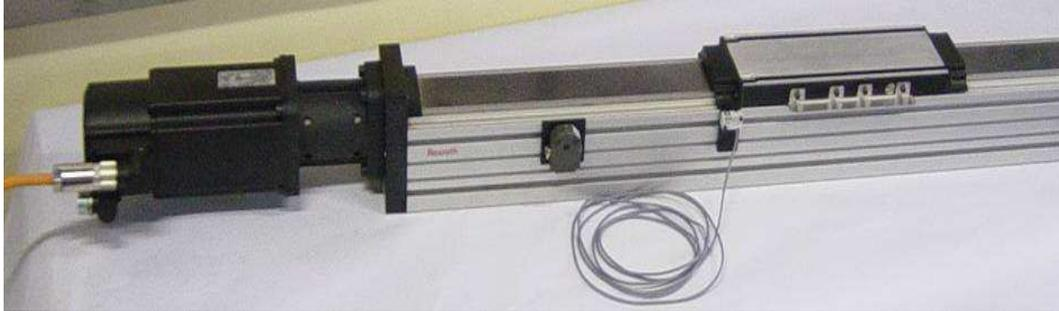
Figura 5.1: Módulo de posicionamento linear por fuso de esferas.
