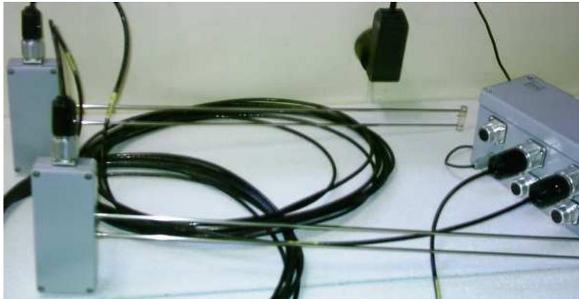
Figura 5.4: Fotografia das sondas de condutância em bancada.
