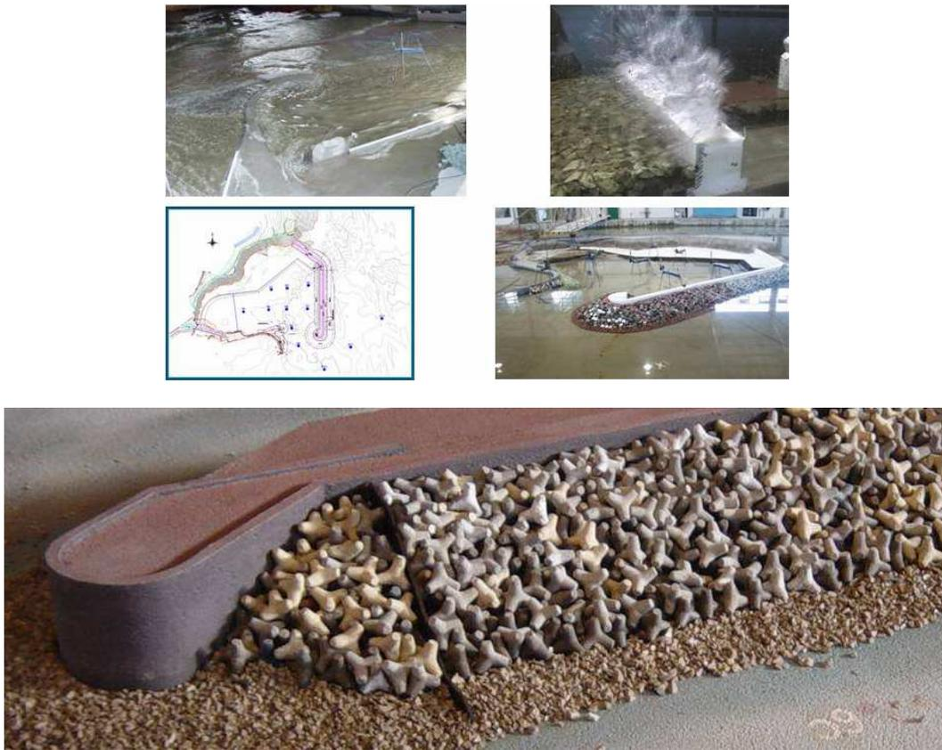
Figura 1.1: Modelos físicos destinados ao ensaio de estruturas hidráulicas.
