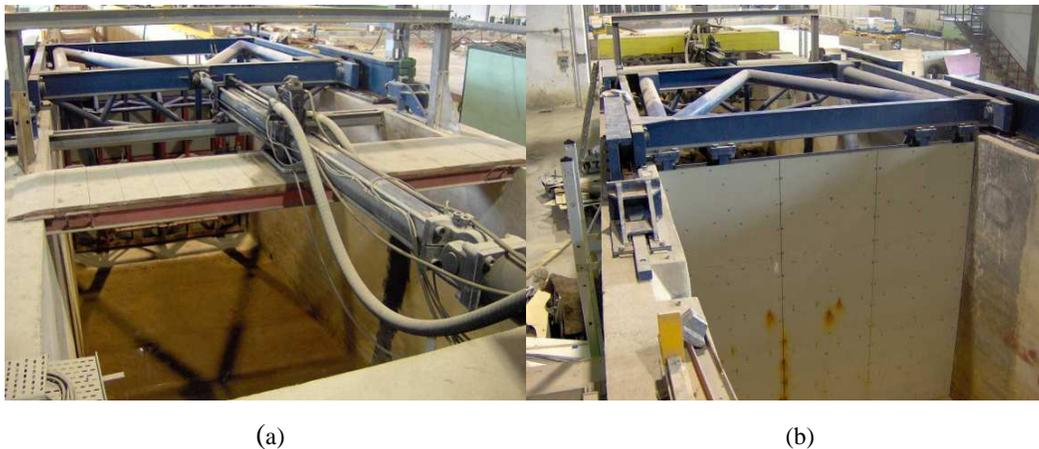
Figura 1.2: Aspecto do gerador de ondas hidráulicas de um dos canais de ondas irregulares do LNEC.
