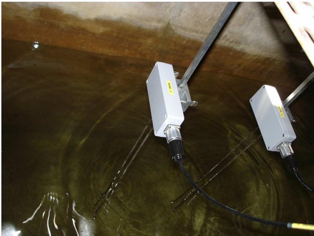
Figura 5.6: Fotografia das sondas de condutância montadas no Canal.
