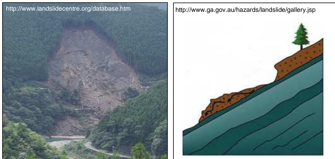
Figura 2.8 – Fotografia e esquema de um movimento do tipo fluxo de detritos.
