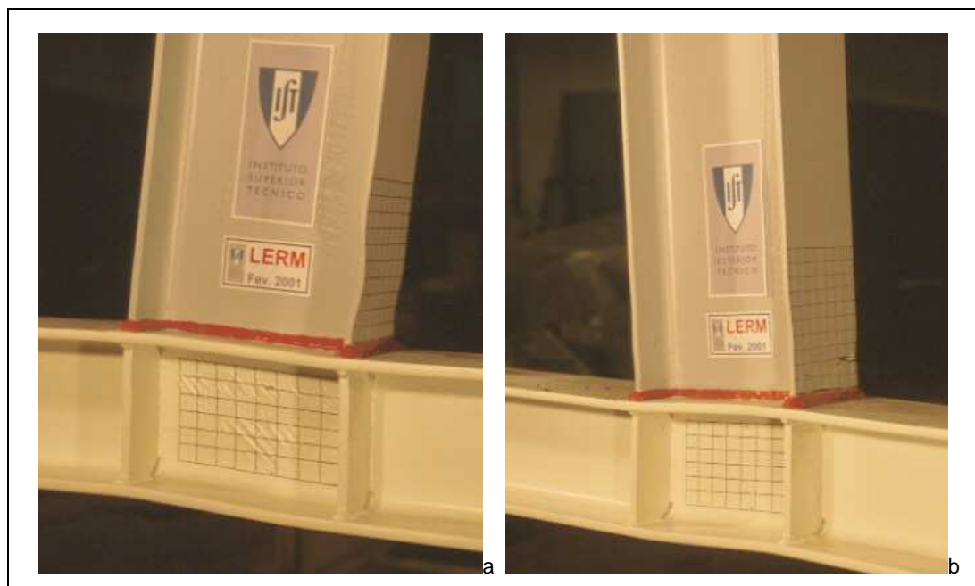
Figura 6.25 – Fotografias do modelo WW-S1: (a) deformada, (b) início da rotura nos banzos da viga.
