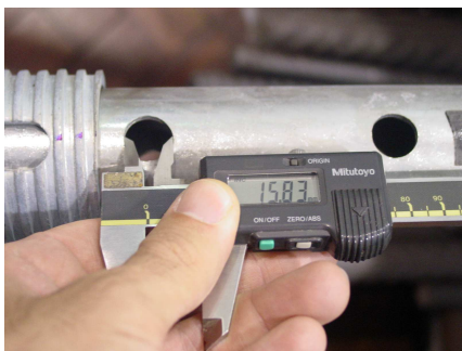
Figura B.12 – Ovalização do furo do tubo interior para L=2,50 m (config. normal).
