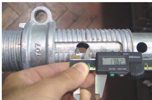
Figura B.13 – Ovalização do furo do tubo interior para L=2,50 m (config. invertida).
