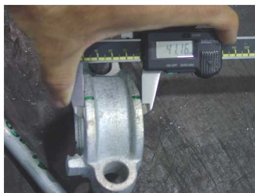
Figura 6.8 – Altura do batente
