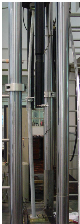
Figura B.18 – Configuração do prumo na força máxima para L=3,25 m (config. normal).
