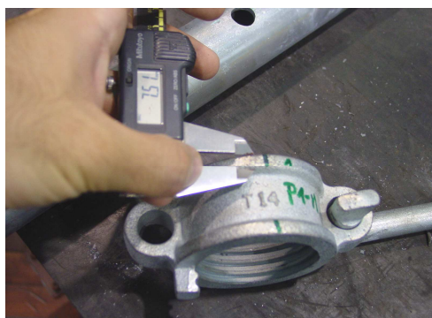
Figura 6.5 – Altura do batente da porca rosçada.
