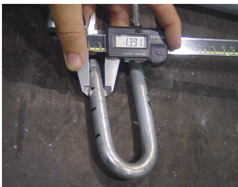
Figura 6.3 – Diâmetro do pino.
