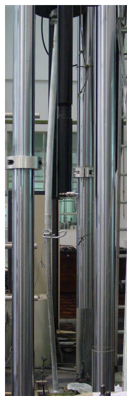
Figura B.19 – Configuração do prumo na força máxima para L=3,25 m (config. invertida).
