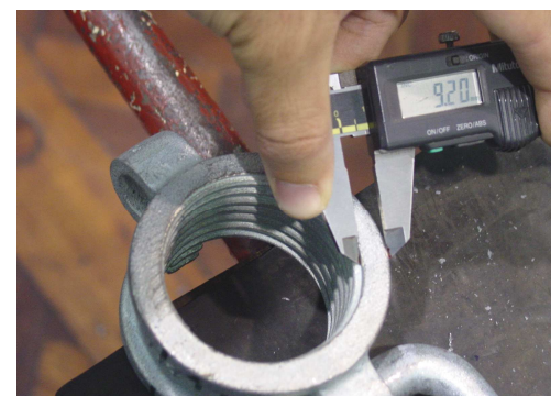
Figura 6.6 – Largura do batente da porca rosçada.
