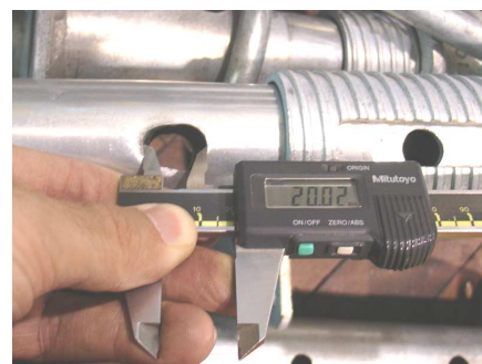
Figura B.11 – Ovalização do furo do tubo interior, L=2,25 m (configuração normal).
