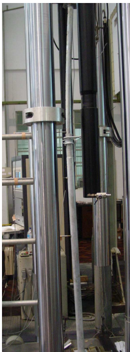
Figura B.16 – Configuração do prumo na força máxima para L=3,00 m (config. normal).
