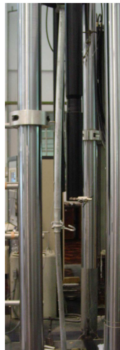
Figura B.17 – Configuração do prumo na força máxima para L=3,00 m (config. invertida).
