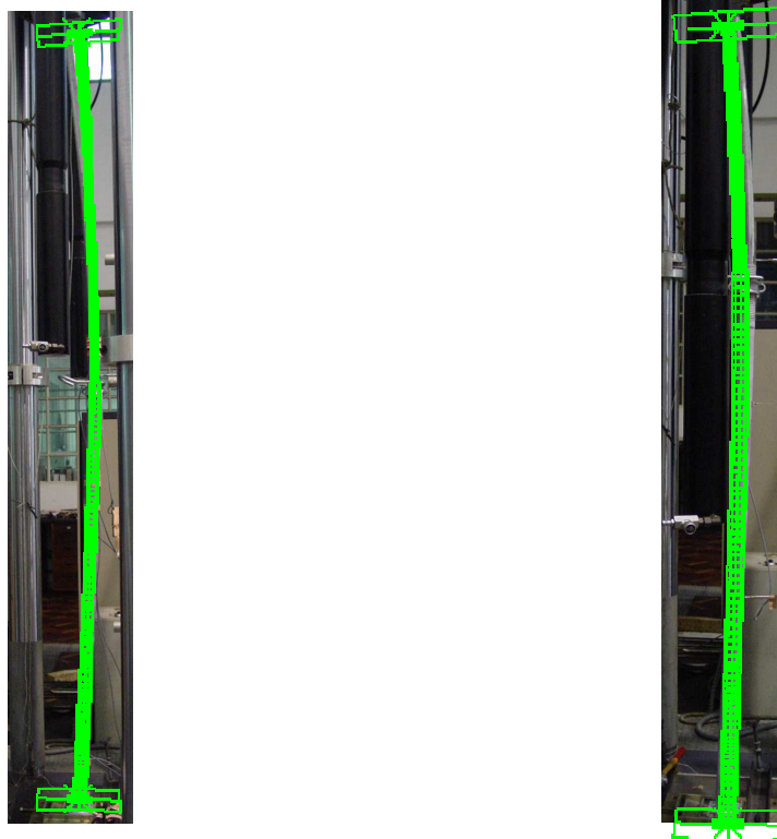
Figura 4.35 – Sobreposição de deformadas obtidas pelo modelo ABAQUS E.5 e nos ensaios para L=3,5 m (à esquerda) e L=2,75 m (à direita).
