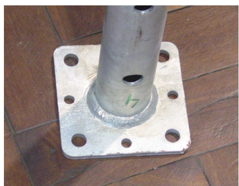
Figura 6.9 – Base do tubo interior.
