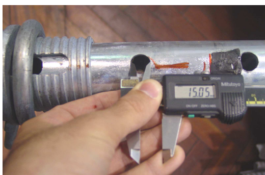
Figura B.14 – Ovalização do furo do tubo interior para L=2,75 m (config. normal).
