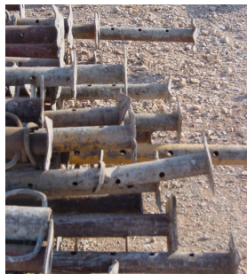
Figura 2.11 – Defeitos nas chapas das bases dos prumos.
