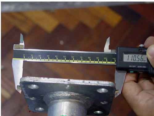
Figura 6.15 – Largura da base do tubo interior.
