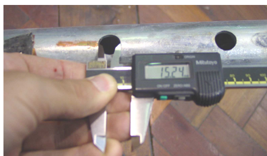
Figura B.15 – Ovalização do furo do tubo interior para L=2,75 m (config. invertida).
