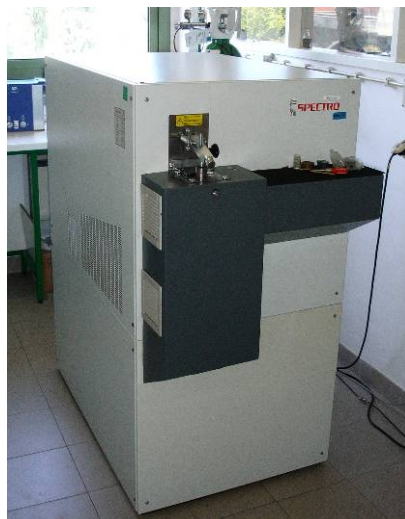
Figura 4.22 – Equipamento utilizado para a determinação da composição química
