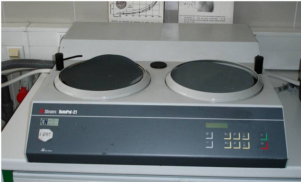
Figura 4.12 – Equipamento utilizado para o desbaste em lixa e para o polimento das amostras.
