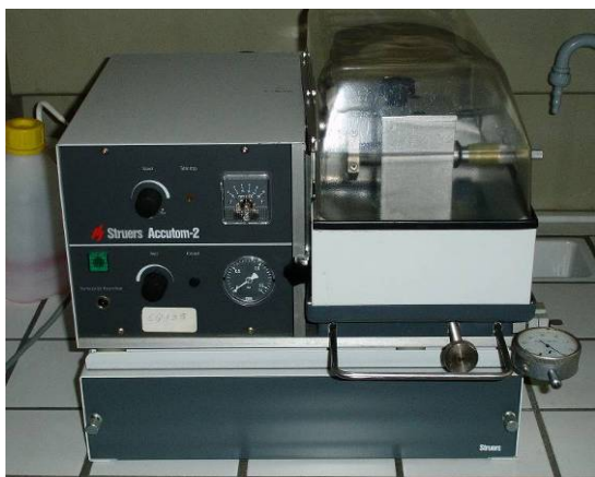
Figura 4.10 – Equipamento utilizado para o corte das amostras.
