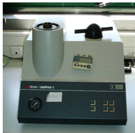
Figura 4.11 – Equipamento utilizado para o embutimento das amostras na resina.
