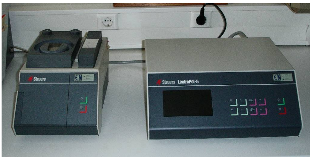
Figura 4.13 – Equipamento utilizado para se efectuar o ataque electroquímico.
