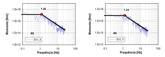
Figura C.6d – Espectros de amplitude de deslocamento, para o sismo de 29 de Julho de 2003, para as duas componentes horizontais, da estação SVI.
