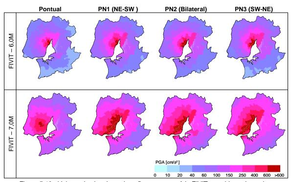
Figura 5.13 - Valores de pico de aceleração, para o cenário FIVIT, considerando as duas magnitudes, os 3 pontos de nucleação (PN) e a fonte pontual.
