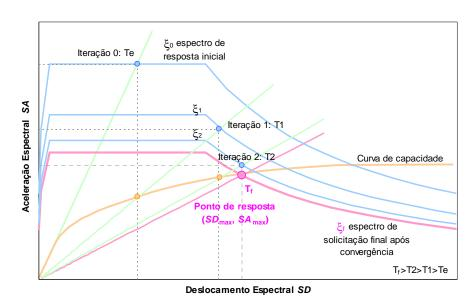
Figura 5.7 - Procedimento iterativo da metodologia FEMA & NIBS conducente à determinação da resposta máxima do edifício [Sousa, 2006]
