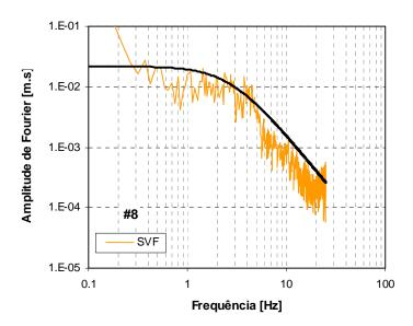
Figura C.20c – Espectros de amplitude de Fourier em deslocamento da fonte sísmica, para o sismo de 29 de Dezembro de 2005, da estação SVF. A preto: espectro teórico de Brune.
