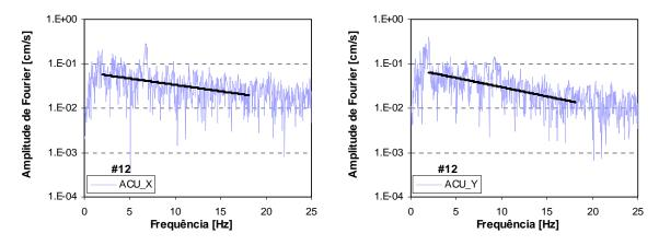
Figura B.12a – Espectros de aceleração e respectivo ajuste linear para o sismo de 12 de Fevereiro de 2007, para as duas componentes horizontais, da estação ACU.
