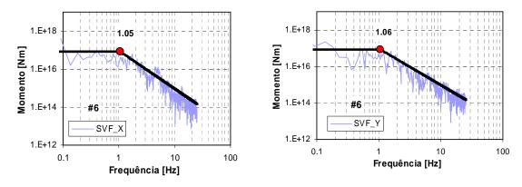
Figura C.6a – Espectros de amplitude de deslocamento, para o sismo de 29 de Julho de 2003, para as duas componentes horizontais, da estação SVF.
