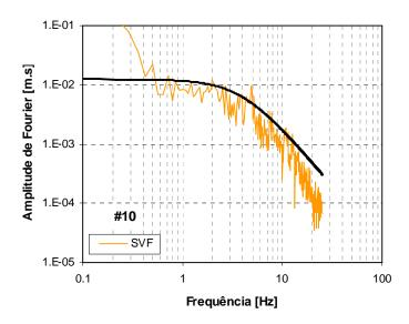
Figura C.22 – Espectros de amplitude de Fourier em deslocamento da fonte sísmica, para o sismo de 15 de Abril de 2006, da estação SVF. A preto: espectro teórico de Brune.
