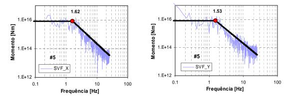
Figura C.5 – Espectros de amplitude de deslocamento, para o sismo de 24 de Julho de 2002, para as duas componentes horizontais, da estação SVF.
