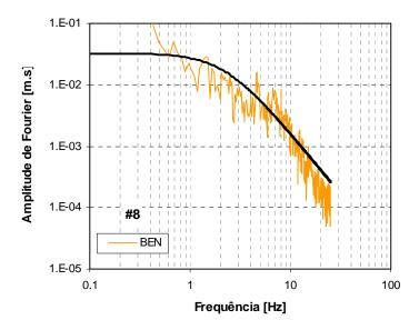
Figura C.20a – Espectros de amplitude de Fourier em deslocamento da fonte sísmica, para o sismo de 29 de Dezembro de 2005, da estação BEN. A preto: espectro teórico de Brune.
