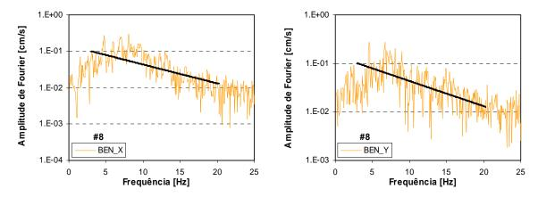
Figura B.8a – Espectros de aceleração e respectivo ajuste linear para o sismo de 29 de Dezembro de 2005, para as duas componentes horizontais, da estação BEN.
