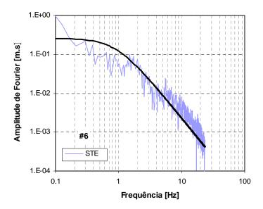
Figura C.18b – Espectros de amplitude de Fourier em deslocamento da fonte sísmica, para o sismo de 29 de Julho de 2003, da estação STE. A preto: espectro teórico de Brune.
