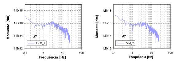
Figura C.7c – Espectros de amplitude de deslocamento, para o sismo de 13 de Dezembro de 2004, para as duas componentes horizontais, da estação EVM.
