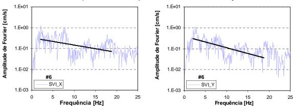
Figura B.6d – Espectros de aceleração e respectivo ajuste linear para o sismo de 29 de Julho de 2003, para as duas componentes horizontais, da estação SVI.
