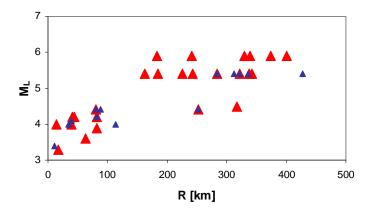
Figura 3.3 - Distribuição de magnitudes,  $M_L$ , e distâncias hipocentrais, R, dos registos obtidos na rede acelerográfica continental.  $\triangle$  - registos não considerados neste estudo.
