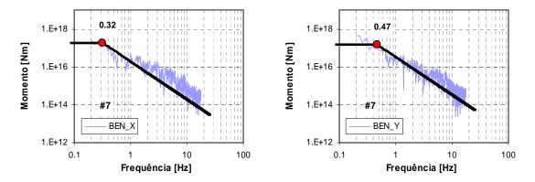
Figura C.7b – Espectros de amplitude de deslocamento, para o sismo de 13 de Dezembro de 2004, para as duas componentes horizontais, da estação BEN.
