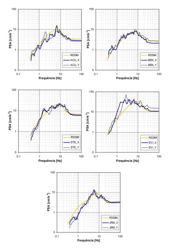
Figura 4.7 - Comparação dos espectros de resposta obtidos e simulados para as estações que registaram o sismo de 12 Fevereiro de 2007 e consideradas neste trabalho.
