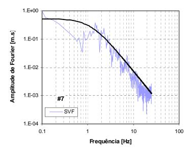
Figura C.19a – Espectros de amplitude de Fourier em deslocamento da fonte sísmica, para o sismo de 13 de Dezembro de 2004, da estação SVF. A preto: espectro teórico de Brune.
