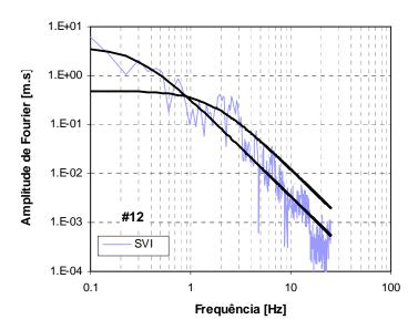
Figura C.24e – Espectros de amplitude de Fourier em deslocamento da fonte sísmica, para o sismo de 12 de Fevereiro de 2007, da estação SVI. A preto: espectro teórico de Brune.
