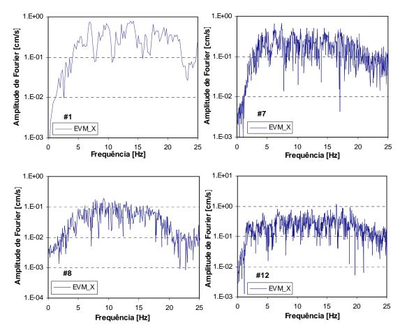
Figura 3.18 - Espectros de amplitude em aceleração para os eventos registados na estação de Évora Monte (EVM).
