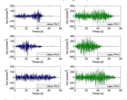
Figura 4.41 - Séries temporais em aceleração para Lisboa e Lagos, para o modelo CMP – FISBG (ver Figura 4.34).
