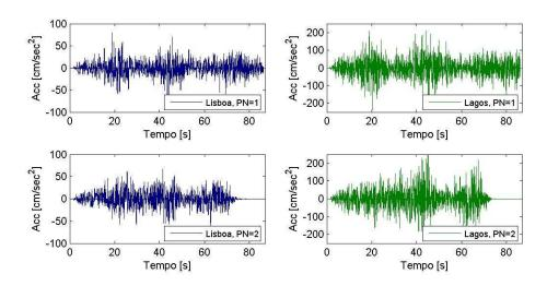
Figura 4.43 - Séries temporais em aceleração para Lisboa e Lagos, para o modelo GQ (ver Figura 4.36).
