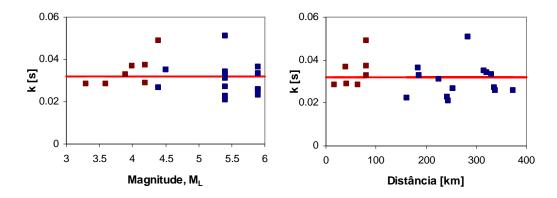
Figura 3.16 - Valores de k em função da magnitude (esquerda) e da distância hipocentral (direita) para todas as estações da base de dados. A cor castanha representa os sismos "terra" e a cor azul os sismos "mar". A recta sólida, a vermelho, representa o valor médio de k.
