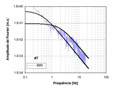
Figura C.19b – Espectros de amplitude de Fourier em deslocamento da fonte sísmica, para o sismo de 13 de Dezembro de 2004, da estação BEN. A preto: espectros teóricos de Brune.
