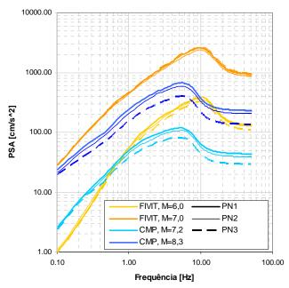
Figura 5.14 - Espectro de resposta, no substracto rochoso, para Lisboa, considerando as 12 simulações de falha
