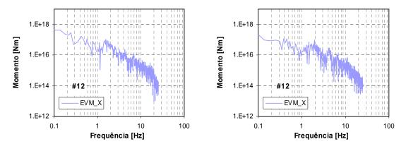
Figura C.12d – Espectros de amplitude de deslocamento, para o sismo de 12 de Fevereiro de 2007, para as duas componentes horizontais, da estação EVM.
