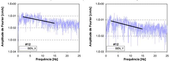
Figura B.12b – Espectros de aceleração e respectivo ajuste linear para o sismo de 12 de Fevereiro de 2007, para as duas componentes horizontais, da estação BEN.
