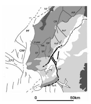
Figura 5.10 - Estruturas principais da Bacia Lusitânia, da Bacia do Vale Inferior do Tejo e da Plataforma continental adjacente [Vilanova, 2004]. VF –Falha de Vila Franca de Xira; AzF – Falha da Asseca.
