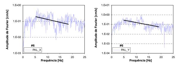
Figura B.6c – Espectros de aceleração e respectivo ajuste linear para o sismo de 29 de Julho de 2003, para as duas componentes horizontais, da estação PAL.
