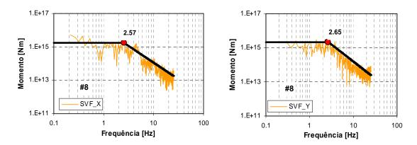
Figura C.8c – Espectros amplitude de deslocamento, para o sismo de 29 de Dezembro de 2005, para as duas componentes horizontais, da estação SVF.
