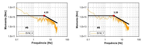
Figura C.8b – Espectros de amplitude de deslocamento, para o sismo de 29 de Dezembro de 2005, para as duas componentes horizontais, da estação EVM.
