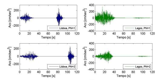
Figura 4.44 - Séries temporais em aceleração para Lisboa e Lagos, para os modelos FIVIT – CMP e FIVIT – CBG (ver Figura 4.37).
