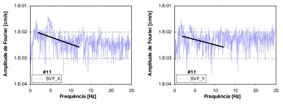
Figura B.11 – Espectros de aceleração e respectivo ajuste linear para o sismo de 21 de Junho de 2006, para as duas componentes horizontais, da estação SVF.
