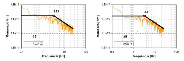
Figura C.9 – Espectros de amplitude de deslocamento, para o sismo de 29 de Dezembro de 2005, para as duas componentes horizontais, da estação ACU.
