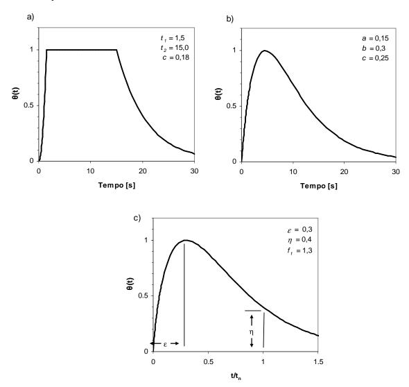
Figura 2.13 - Funções de modulação determinísticas utilizadas por a) Amin & Ang [1968]; b) Shinozuka & Sato [1967]; c) Saragoni & Hart [1974]
