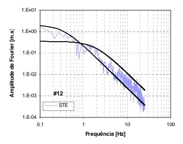
Figura C.24c – Espectros de amplitude de Fourier em deslocamento da fonte sísmica, para o sismo de 12 de Fevereiro de 2007, da estação STE. A preto: espectro teórico de Brune.
