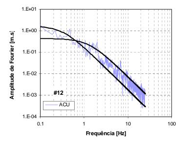
Figura C.24a – Espectros de amplitude de Fourier em deslocamento da fonte sísmica, para o sismo de 12 de Fevereiro de 2007, da estação ACU. A preto: espectro teórico de Brune.
