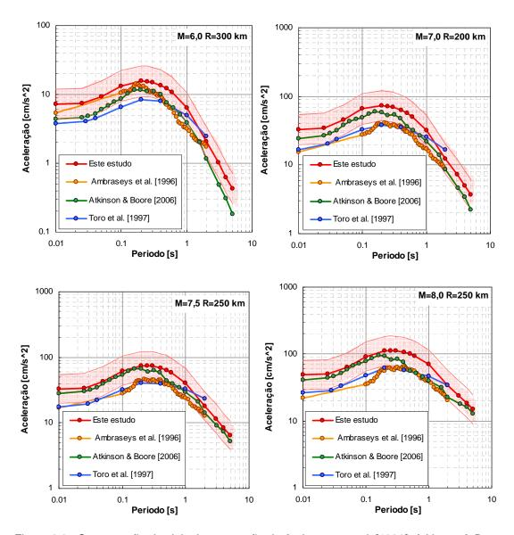
Figura 6.6 - Comparação das leis de atenuação de Ambraseys et al. [1996], Atkinson & Boore [2006], Toro et al. [1997] com as leis deste estudo para o cenário CMP. A faixa a vermelho traduz a incerteza estimada (lei  $\pm \sigma_{\epsilon}$ ).
