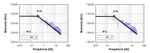
Figura C.12f – Espectros de amplitude de deslocamento, para o sismo de 12 de Fevereiro de 2007, para as duas componentes horizontais, da estação JR1.
