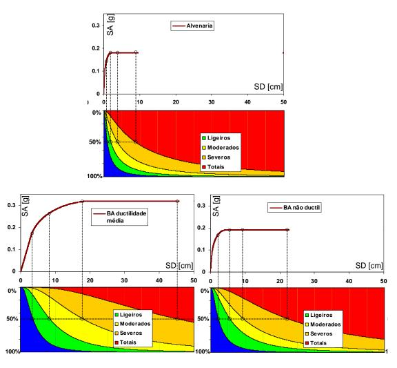
Figura 5.8 - Curvas de capacidade, fragilidade e limiares de dano para as 3 tipologias consideradas.
