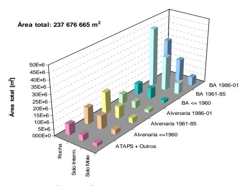
Figura 5.5 - Área total  $[m^2]$ , na AML, por classe tipológica e tipo de solo.
