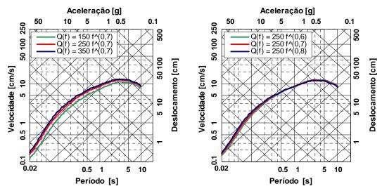
Figura 2.23 - Variação do espectro de resposta com a relação do factor de qualidade  $Q(f) = Q_o f^{\nu}$ . Esquerda: variação da constante,  $Q_o$ . Direita: variação com o expoente, v.
