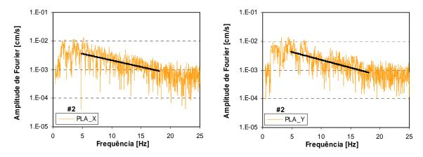
Figura B.2 – Espectros de aceleração e respectivo ajuste linear para o sismo 20 de Setembro de 1999, para as duas componentes horizontais, da estação PLA.
