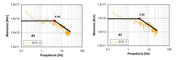
Figura C.3 – Espectros de amplitude de deslocamento, para o sismo de 16 de Outubro de 2000, para as duas componentes horizontais, da estação SVF.
