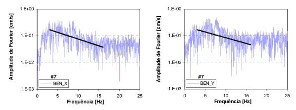
Figura B.7b – Espectros de aceleração e respectivo ajuste linear para o sismo de 13 de Dezembro de 2004, para as duas componentes horizontais, da estação BEN.
