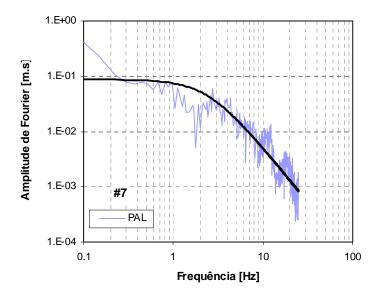
Figura C.19d – Espectros de amplitude de Fourier em deslocamento da fonte sísmica, para o sismo de 13 de Dezembro de 2004, da estação PAL. A preto: espectro teórico de Brune.
