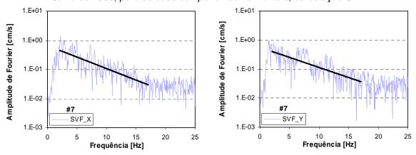
Figura B.7a – Espectros de aceleração e respectivo ajuste linear para o sismo de 13 de Dezembro de 2004, para as duas componentes horizontais, da estação SVF.
