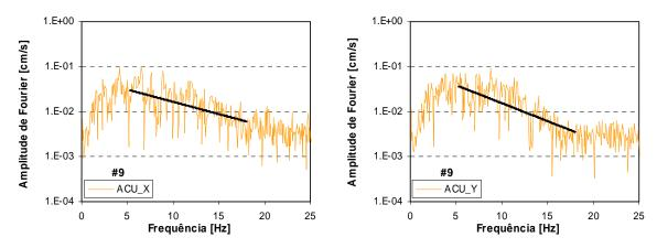
Figura B.9 – Espectros de aceleração e respectivo ajuste linear para o sismo de 29 de Dezembro de 2005, para as duas componentes horizontais, da estação ACU.
