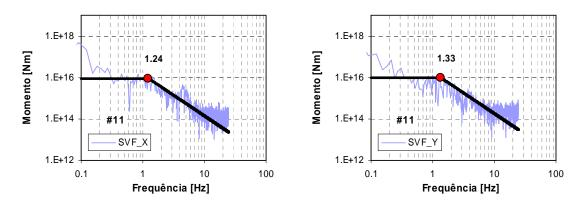
Figura C.11 – Espectros de amplitude de deslocamento, para o sismo de 21 de Junho de 2006, para as duas componentes horizontais, da estação SVF.
