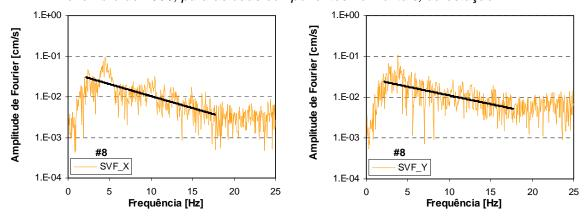
Figura B.8c – Espectros de aceleração e respectivo ajuste linear para o sismo de 29 de Dezembro de 2005, para as duas componentes horizontais, da estação SVF.
