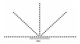
Figura 6.1 - Geometria dos locais a considerar nas simulações (apenas está apresentado metade do circulo) [adaptado de Atkinson & Boore, 2006]
