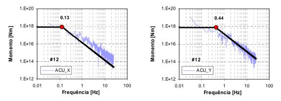
Figura C.12a – Espectros de amplitude de deslocamento, para o sismo de 12 de Fevereiro de 2007, para as duas componentes horizontais, da estação ACU.
