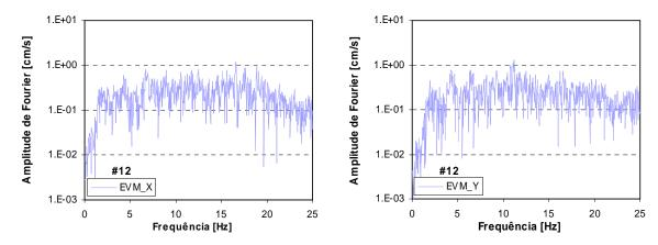
Figura B.12d – Espectros de aceleração e respectivo ajuste linear para o sismo de 12 de Fevereiro de 2007, para as duas componentes horizontais, da estação EVM.
