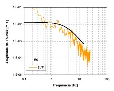
Figura C.16 – Espectros de amplitude de Fourier em deslocamento da fonte sísmica, para o sismo de 28 de Março de 2002, da estação SVF. A preto: espectro teórico de Brune.
