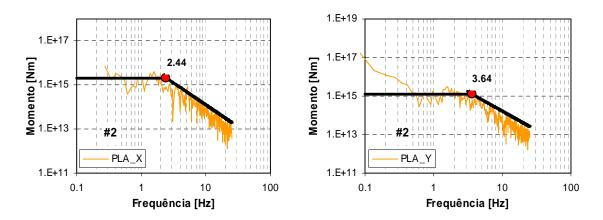
Figura C.2 – Espectros de amplitude de deslocamento, para o sismo 20 de Setembro de 1999, para as duas componentes horizontais, da estação PLA.
