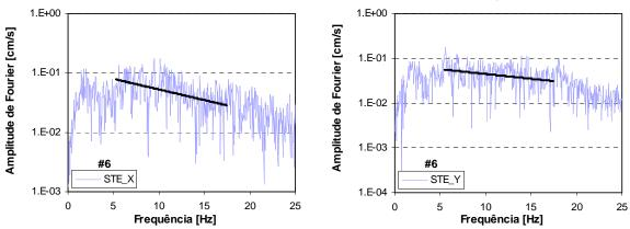
Figura B.6b – Espectros de aceleração e respectivo ajuste linear para o sismo de 29 de Julho de 2003, para as duas componentes horizontais, da estação STE.
