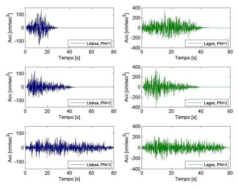
Figura 4.38 - Séries temporais em aceleração para Lisboa e Lagos, para o modelo CMP (ver Figura 4.31).
