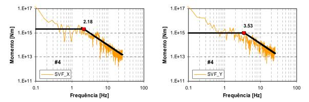
Figura C.4 – Espectros de amplitude de deslocamento, para o sismo de 28 de Março de 2002, para as duas componentes horizontais, da estação SVF.
