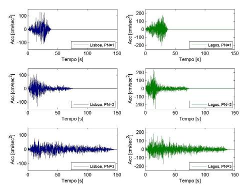
Figura 4.39 - Séries temporais em aceleração para Lisboa e Lagos, para o modelo CBG (ver Figura 4.32).
