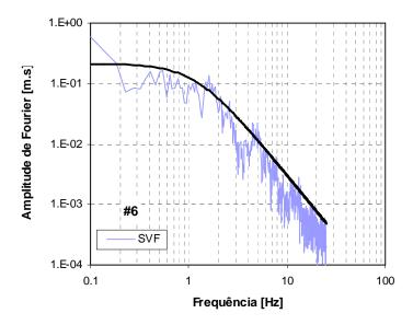
Figura C.18a – Espectros de amplitude de Fourier em deslocamento da fonte sísmica, para o sismo de 29 de Julho de 2003, da estação SVF. A preto: espectro teórico de Brune.
