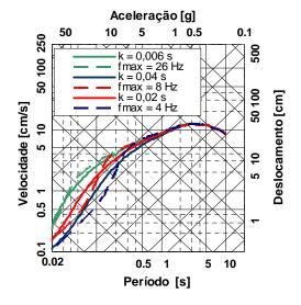
Figura 2.27 - Variação do espectro de resposta com os parâmetros k e  $f_{max}$ .
