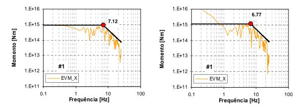
Figura C.1 – Espectros de amplitude de deslocamento, para o sismo de 31 de Julho de 1998, para as duas componentes horizontais, da estação EVM.
