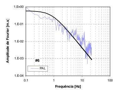
Figura C.18c – Espectros de amplitude de Fourier em deslocamento da fonte sísmica, para o sismo de 29 de Julho de 2003, da estação PAL. A preto: espectro teórico de Brune.
