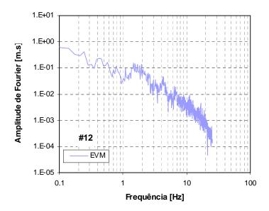
Figura C.24d – Espectros de amplitude de Fourier em deslocamento da fonte sísmica, para o sismo de 12 de Fevereiro de 2007, da estação EVM.
