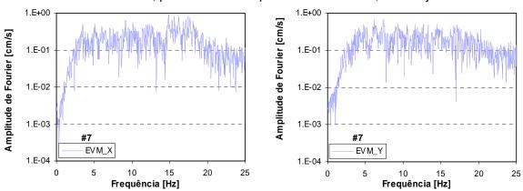
Figura B.7c – Espectros de aceleração e respectivo ajuste linear para o sismo de 13 de Dezembro de 2004, para as duas componentes horizontais, da estação EVM.
