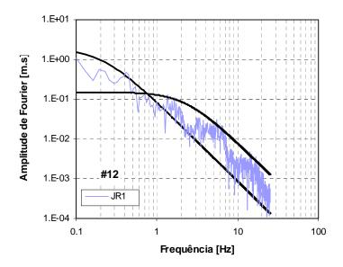
Figura C.24f – Espectros de amplitude de Fourier em deslocamento da fonte sísmica, para o sismo de 12 de Fevereiro de 2007, da estação JR1. A preto: espectro teórico de Brune.
