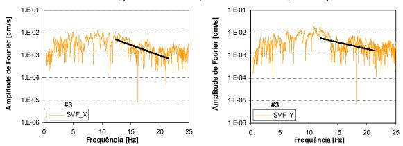
Figura B.3 – Espectros de aceleração e respectivo ajuste linear para o sismo de 16 de Outubro de 2000, para as duas componentes horizontais, da estação SVF.
