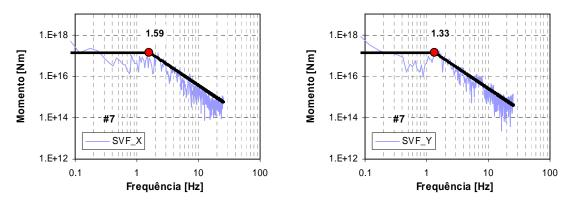
Figura C.7a – Espectros de amplitude de deslocamento, para o sismo de 13 de Dezembro de 2004, para as duas componentes horizontais, da estação SVF.
