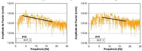
Figura B.10 – Espectros de aceleração e respectivo ajuste linear para o sismo de 15 de Abril de 2006, para as duas componentes horizontais, da estação SVF.
