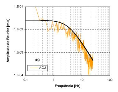
Figura C.21 – Espectros de amplitude de Fourier em deslocamento da fonte sísmica, para o sismo de 29 de Dezembro de 2005, da estação ACU. A preto: espectro teórico de Brune.
