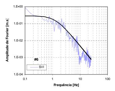
Figura C.18d – Espectros de amplitude de Fourier em deslocamento da fonte sísmica, para o sismo de 29 de Julho de 2003, da estação SVI. A preto: espectro teórico de Brune.
