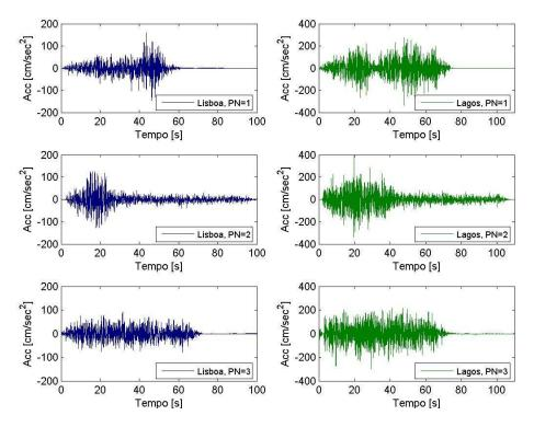
Figura 4.42 - Séries temporais em aceleração para Lisboa e Lagos, para o modelo CPF –CMP (ver Figura 4.35).
