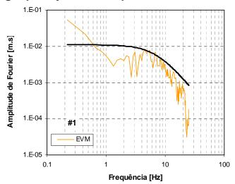
Figura C.13 – Espectros de amplitude de Fourier em deslocamento da fonte sísmica, para o sismo de 31 de Julho de 1998, da estação EVM. A preto: espectro teórico de Brune.
