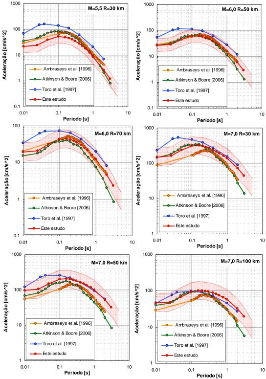
Figura 6.5 - Comparação das leis de atenuação de Ambraseys et al. [1996], Atkinson & Boore [2006], Toro et al. [1997] com as leis deste estudo para o cenário FIVIT. A faixa a vermelho traduz a incerteza estimada (lei  $\pm \sigma_{\epsilon}$ ).
