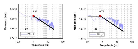
Figura C.7d – Espectros de amplitude de deslocamento, para o sismo de 13 de Dezembro de 2004, para as duas componentes horizontais, da estação PAL.
