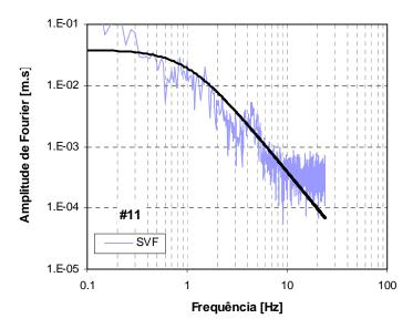
Figura C.23 – Espectros de amplitude de Fourier em deslocamento da fonte sísmica, para o sismo de 21 de Junho de 2006, da estação SVF. A preto: espectro teórico de Brune.
