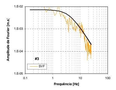
Figura C.15 – Espectros de amplitude de Fourier em deslocamento da fonte sísmica, para o sismo de 16 de Outubro de 2000, da estação SVF. A preto: espectro teórico de Brune.
