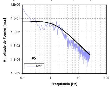
Figura C.17 – Espectros de amplitude de Fourier em deslocamento da fonte sísmica, para o sismo de 24 de Julho de 2002, da estação SVF. A preto: espectro teórico de Brune.
