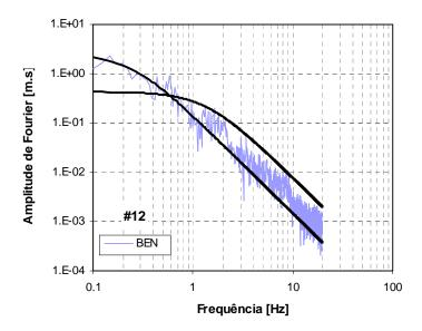
Figura C.24b – Espectros de amplitude de Fourier em deslocamento da fonte sísmica, para o sismo de 12 de Fevereiro de 2007, da estação BEN. A preto: espectro teórico de Brune.
