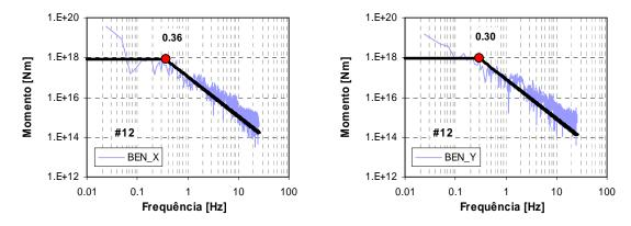
Figura C.12b – Espectros de amplitude de deslocamento, para o sismo de 12 de Fevereiro de 2007, para as duas componentes horizontais, da estação BEN.
