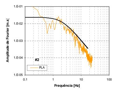
Figura C.14 – Espectros de amplitude de Fourier em deslocamento da fonte sísmica, para o sismo 20 de Setembro de 1999, da estação PLA. A preto: espectro teórico de Brune.
