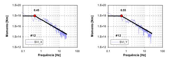
Figura C.12e – Espectros de amplitude de deslocamento, para o sismo de 12 de Fevereiro de 2007, para as duas componentes horizontais, da estação SVI.
