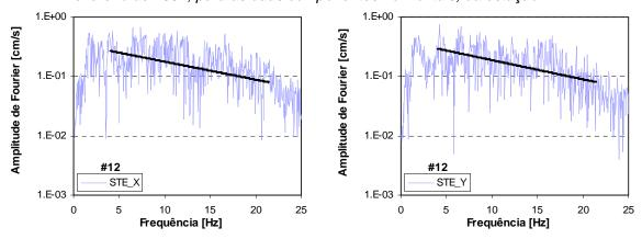
Figura B.12c – Espectros de aceleração e respectivo ajuste linear para o sismo de 12 de Fevereiro de 2007, para as duas componentes horizontais, da estação STE.
