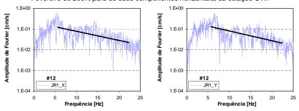
Figura B.12f – Espectros de aceleração e respectivo ajuste linear para o sismo de 12 de Fevereiro de 2007, para as duas componentes horizontais, da estação JR1.
