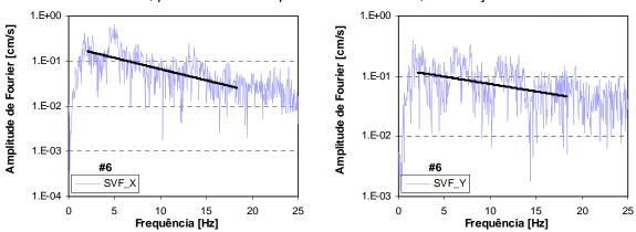
Figura B.6a – Espectros de aceleração e respectivo ajuste linear para o sismo de 29 de Julho de 2003, para as duas componentes horizontais, da estação SVF.
