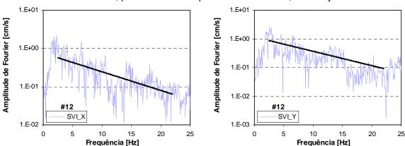
Figura B.12e – Espectros de aceleração e respectivo ajuste linear para o sismo de 12 de Fevereiro de 2007, para as duas componentes horizontais, da estação SVI.
