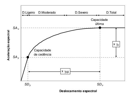
Figura 5.6 - Construção do espectro de capacidade [Sousa, 2006, adaptado de Kircher et al., 1996 e de McGuire, 2004].
