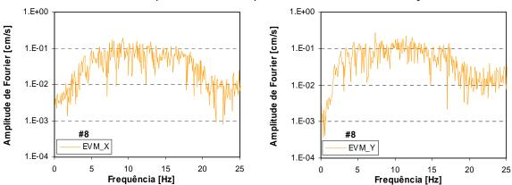
Figura B.8b – Espectros de aceleração e respectivo ajuste linear para o sismo de 29 de Dezembro de 2005, para as duas componentes horizontais, da estação EVM.
