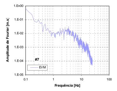
Figura C.19c – Espectros de amplitude de Fourier em deslocamento da fonte sísmica, para o sismo de 13 de Dezembro de 2004, da estação EVM.
