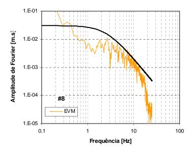
Figura C.20b – Espectros de amplitude de Fourier em deslocamento da fonte sísmica, para o sismo de 29 de Dezembro de 2005, da estação EVM. A preto: espectro teórico de Brune.
