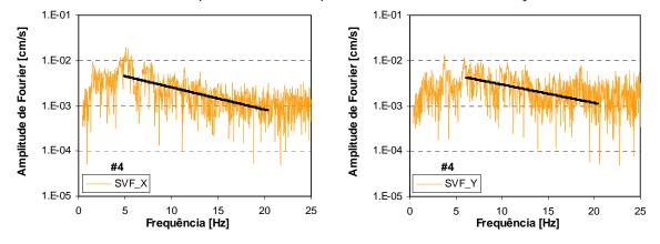
Figura B.4 – Espectros de aceleração e respectivo ajuste linear para o sismo de 28 de Março de 2002, para as duas componentes horizontais, da estação SVF.
