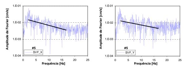
Figura B.5 – Espectros de aceleração e respectivo ajuste linear para o sismo de 24 de Julho de 2002, para as duas componentes horizontais, da estação SVF.
