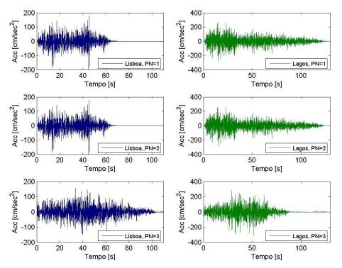
Figura 4.40 - Séries temporais em aceleração para Lisboa e Lagos, para o modelo CMP – FNPS (ver Figura 4.33).
