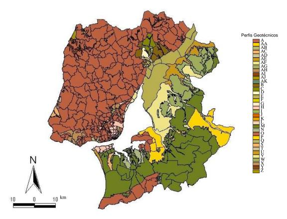
Figura 5.1 - Distribuição geográfica dos perfis geotécnicos na região em estudo [Carvalho et al., 2002]
