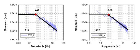
Figura C.12c – Espectros de amplitude de deslocamento, para o sismo de 12 de Fevereiro de 2007, para as duas componentes horizontais, da estação STE.
