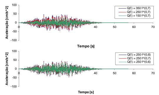
Figura 2.24 - Variação da série temporal com a relação do factor de qualidade  $Q(f) = Q_0 f^{\nu}$ . Em cima: variação da constante,  $Q_0$ . Em baixo: variação com o expoente, v.
