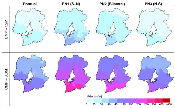
Figura 5.12 - Valores de pico de aceleração, para o cenário CMP, considerando as duas magnitudes, os 3 pontos de nucleação (PN) e a fonte pontual.
