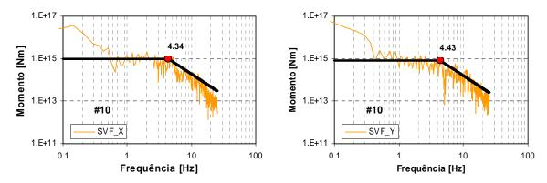
Figura C.10 – Espectros de amplitude de deslocamento, para o sismo de 15 de Abril de 2006, para as duas componentes horizontais, da estação SVF.
