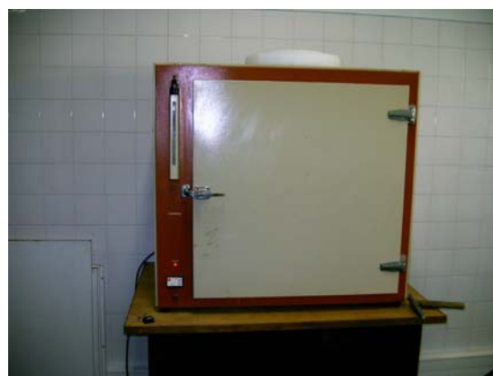
Foto. 18 – Estufa onde se coloca o material para determinação do teor em água.
