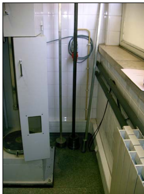
Fig. 5.14 – Pilões de compactação.
