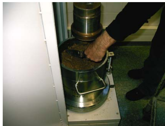
Foto. 8 – Colocação de uma camada de material dentro do molde do Proctor.
