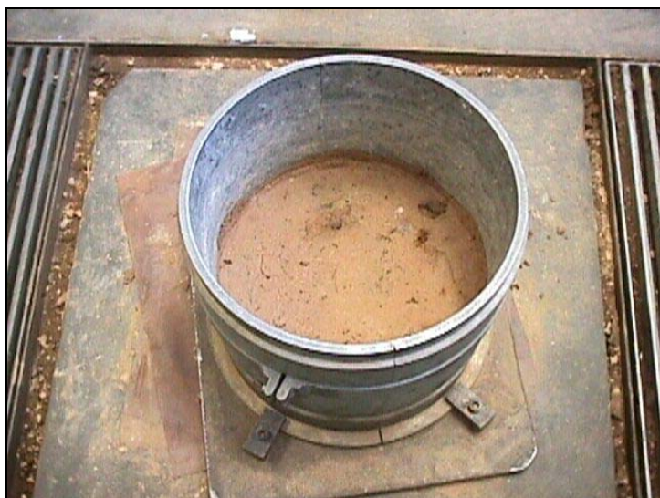
Fig. 5.4 – Molde colapsível com os dois aros aplicados. Fig. 5.5 – Molde e compactador mecânico.
