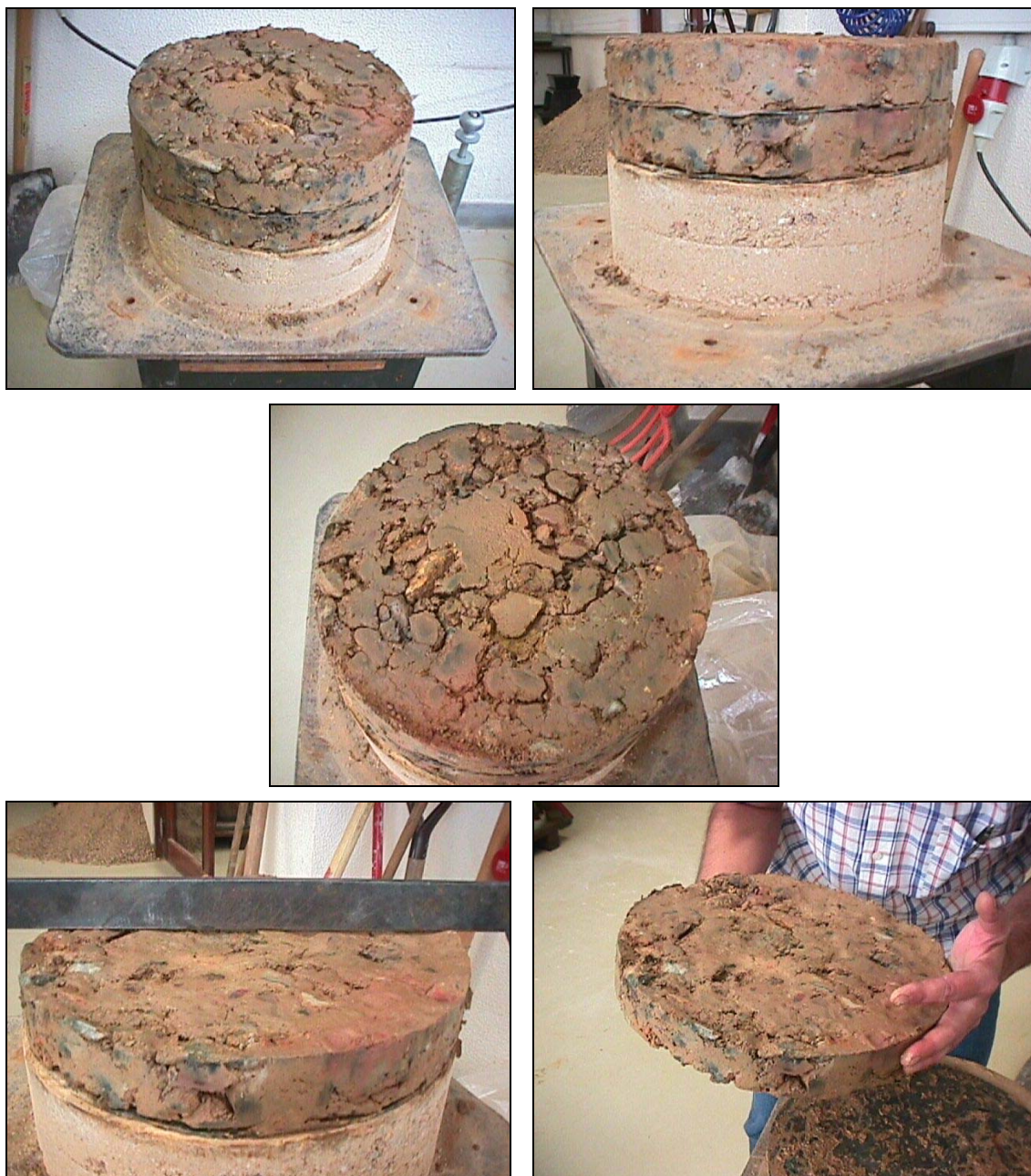
Fig. 5.11 – Provete com 40% de finos e 60% de grosso. Teor em água de 9%.
