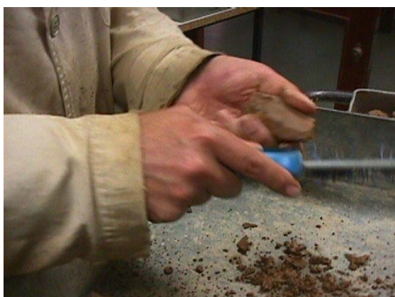
Foto. 15 – Processo de limpeza dos elementos grosseiros para determinação do teor em água do material grosseiro.
