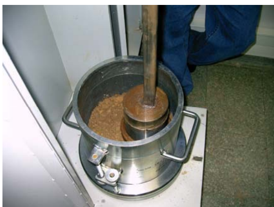
Foto. 9 – Compactador Toni-tecnik a dar as pancadas à camada.
