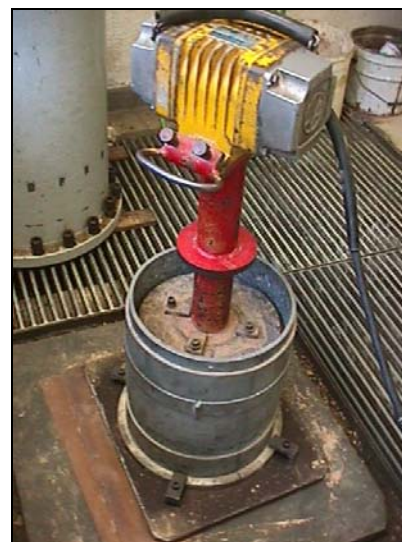
Fig. 5.4 – Molde colapsível com os dois aros aplicados. Fig. 5.5 – Molde e compactador mecânico.
