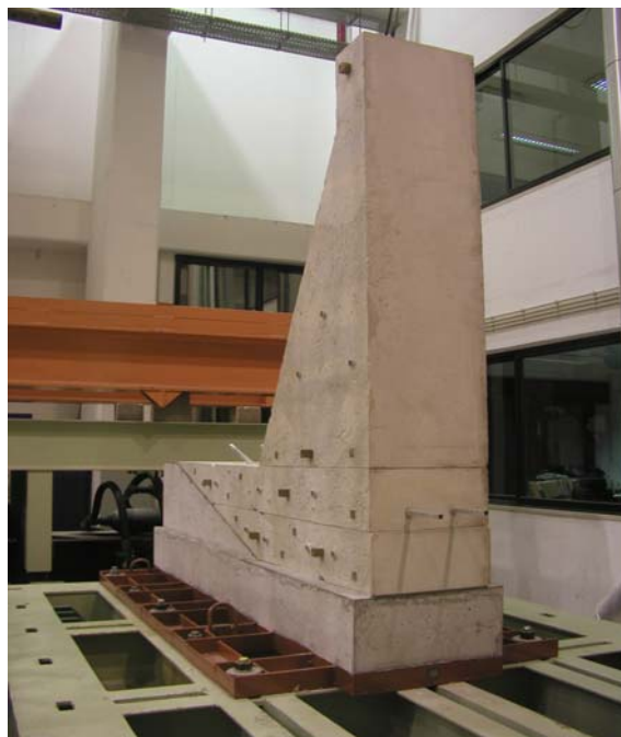
Fig. 6.8 – Vista do modelo colocado sobre a plataforma de ensaio
