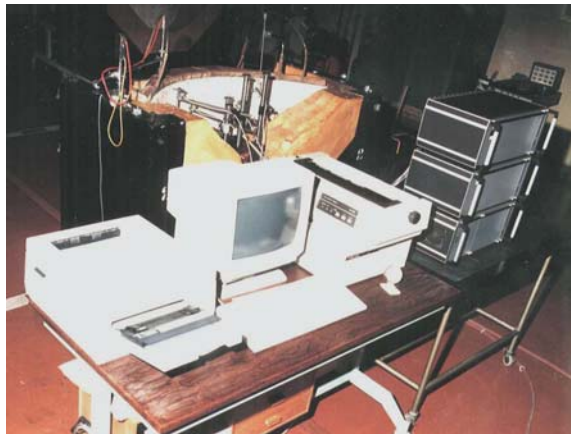
Fig. 2.17 – Vista de um ensaio de um modelo físico de uma barragem para determinação do estado de tensão devido à aplicação da pressão hidrostática
