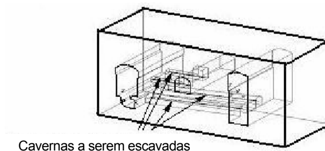
Fig. 4.12 – Vista do sistema de imposição de um estado de tensão num bloco do modelo geomecânico de escavação de galerias [Zhongkui et al, 2003].
