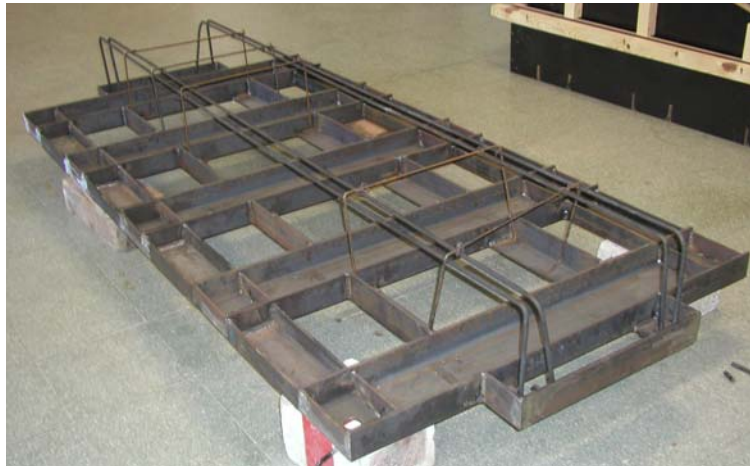
Fig. 6.5 – Vista da base metálica de suporte do modelo
