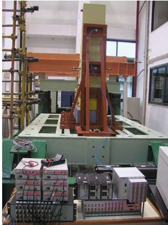
Fig. 6.19 – Vista geral do modelo e do sistema de aquisição
