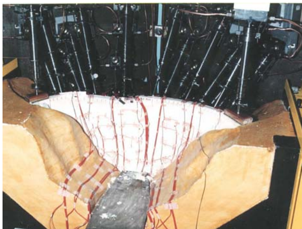
Fig. 2.18 – Vista de jusante após a rotura de um modelo físico de uma barragem para um cenário de deterioração do betão
