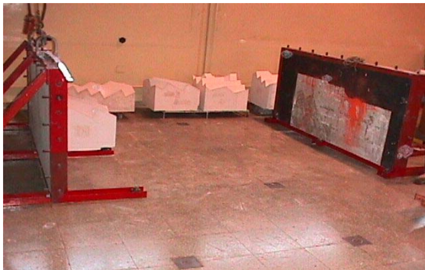
Fig. 5.13 – Vista da zona de implantação do modelo com alguns blocos de gesso para representar a fundação contínua
