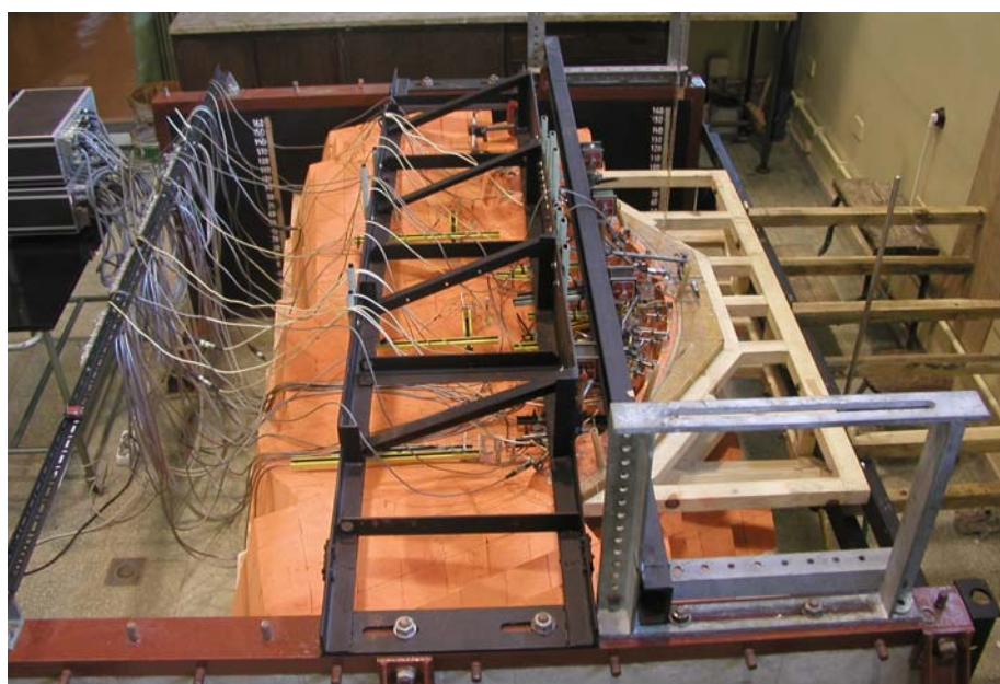
Fig. 5.22 – Vista geral do modelo com a aparelhagem de medida instalada
