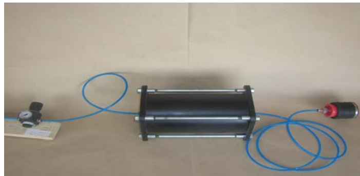
Fig. 6.14 – Pormenor do sistema macaco-depósito de ar utilizado para aplicação das forças de simulação da pressão hidrostática
