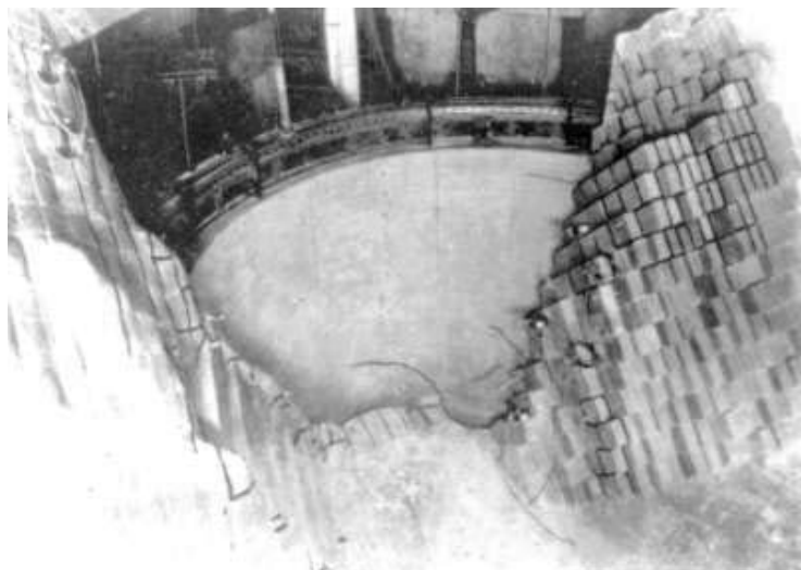
Fig. 4.7 – Modelo geomecânico tridimensional da barragem de Canelles [Fumagalli, 1979]
