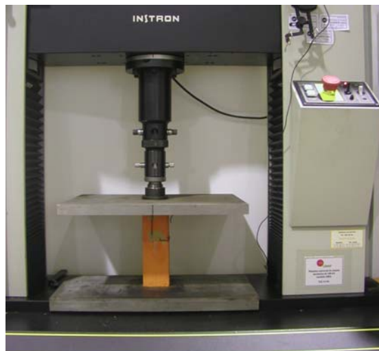
Fig. 5.5 – Vista da realização do ensaio de rotura à compressão
