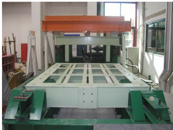
Fig. 6.10 – Vista da mesa sísmica uniaxial
