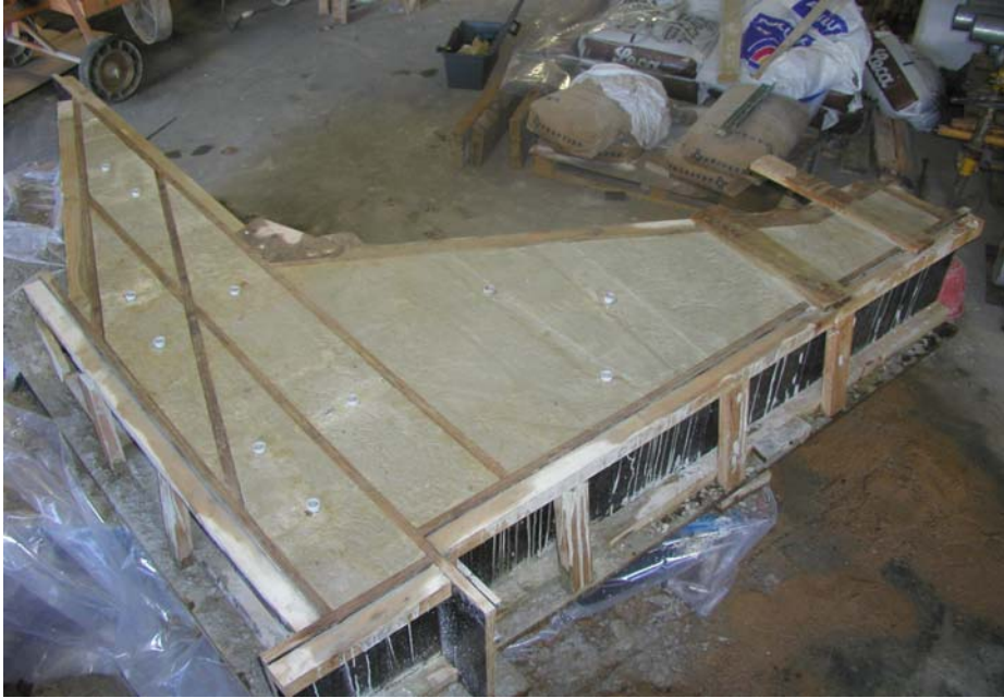
Fig. 6.7 – Vista do molde e dos blocos de argamassa do modelo
