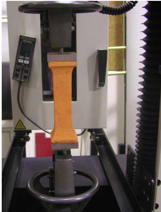
Fig. 5.9 – Vista da realização do ensaio à tracção simples
