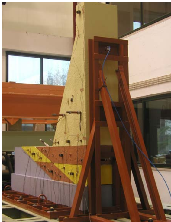
Fig. 6.20 – Vista geral do modelo com a aparelhagem de medida instalada
