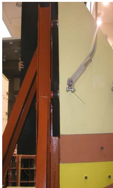
Fig. 6.13 – Pormenor dos macacos pneumáticos para aplicação da pressão hidrostática
