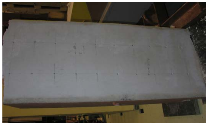
Fig. 6.17 – Vista da furação executada no bloco 2 correspondente à diaclase H2
