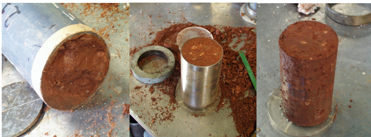
Figura 5.27 - Pormenores da preparação das amostras para ensaios triaxiais
