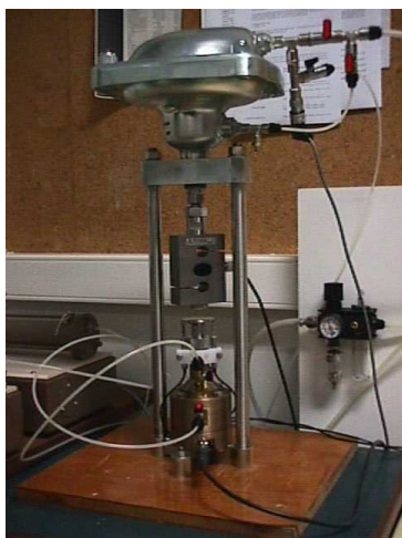
Figura 5.8 - Célula edométrica na configuração de alta pressão
