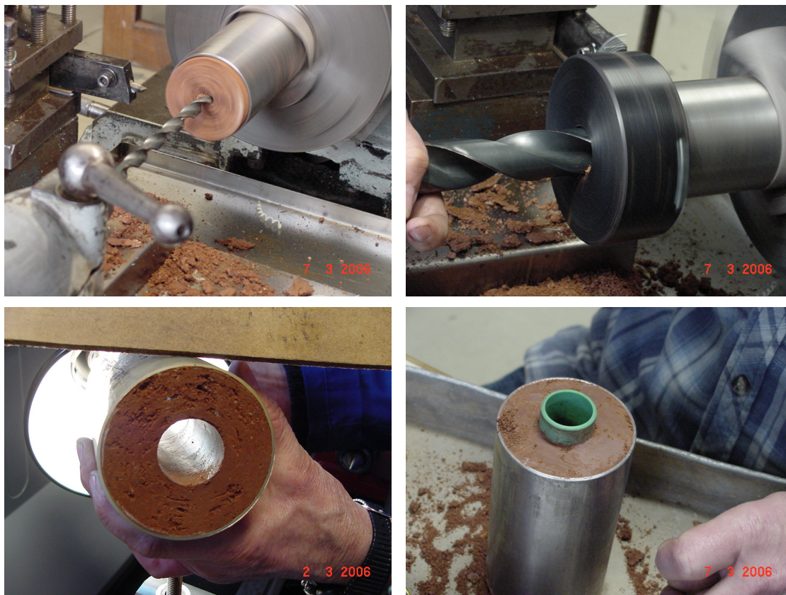
Figura 5.58 - Cravação do amostrador metálico com o diâmetro correspondente ao diâmetro exterior final e realização do furo interior
