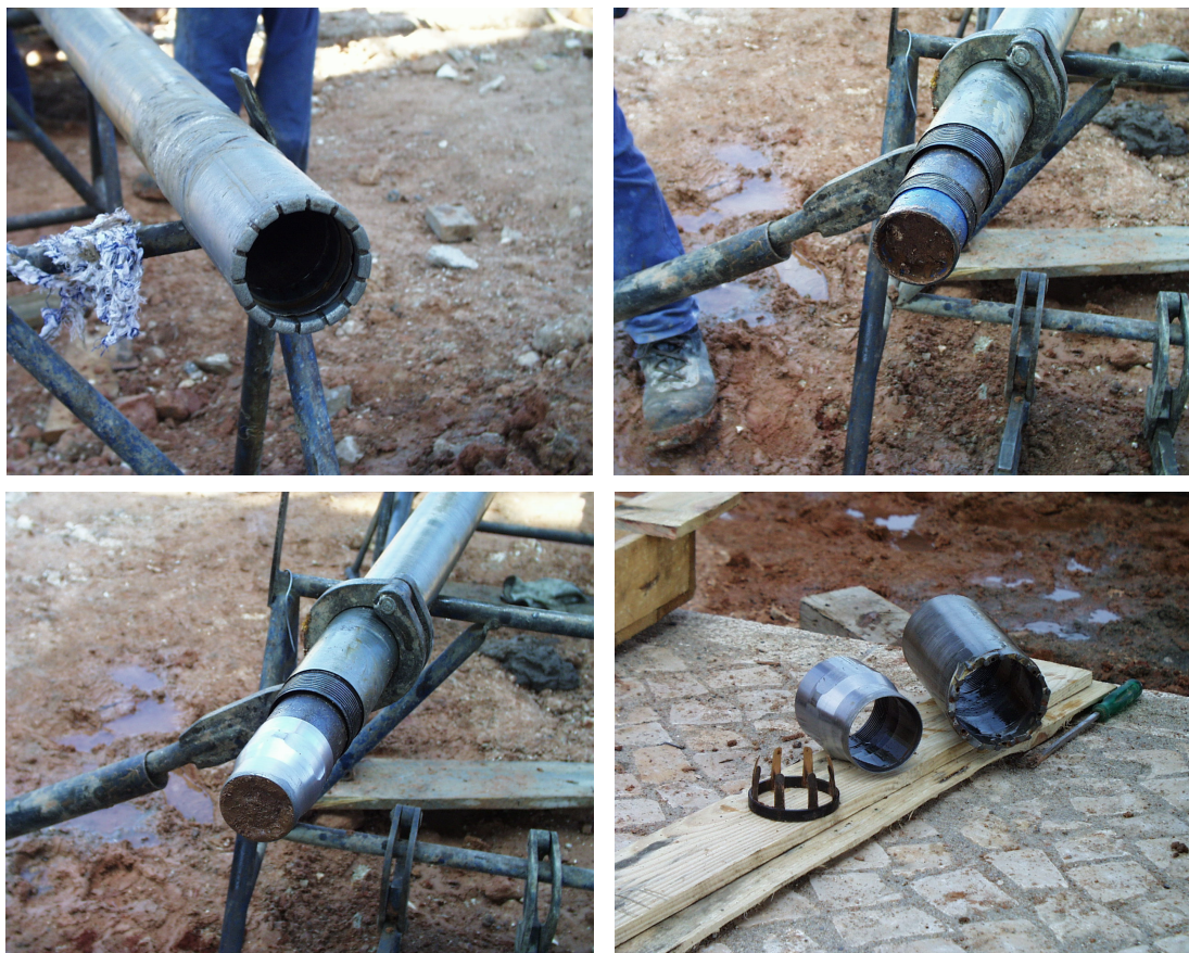
Figura 5.2 - Pormenores do processo de amostragem com recurso a sonda tripla (amostrador tipo Mazier)
