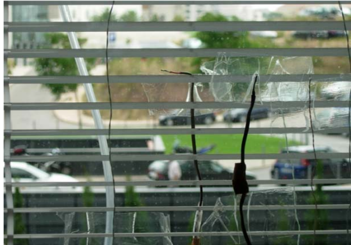
Figura 4.86 - Pormenor de alguns termopares colados no vidro destinados a medir a temperatura superficial do vidro e do ar na caixa-de-ar da fachada
