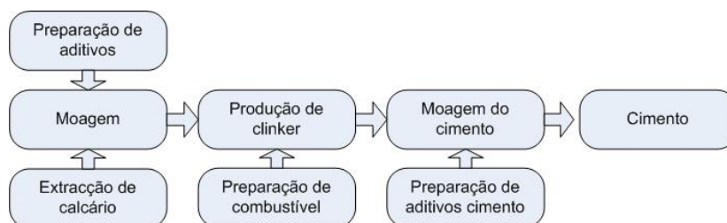
Figura 4.3 - Processo de manufactura de cimento
