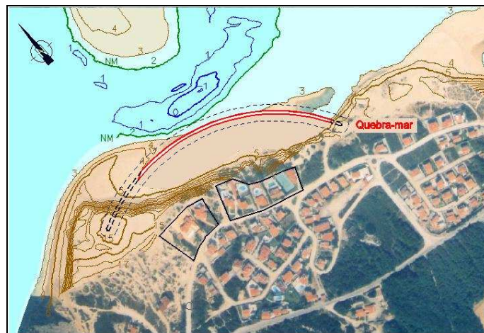
Figura 7 – Quebra-mar aderente à margem (in Clímaco, 2003).
