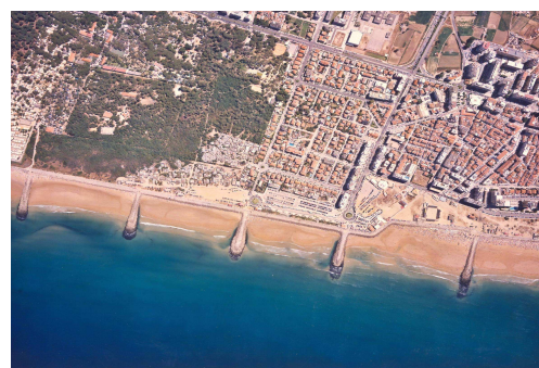
Figura 2 – Exemplos de campos de esporões: restinga do Lobito (Angola) e Costa de Caparica (Portugal).
