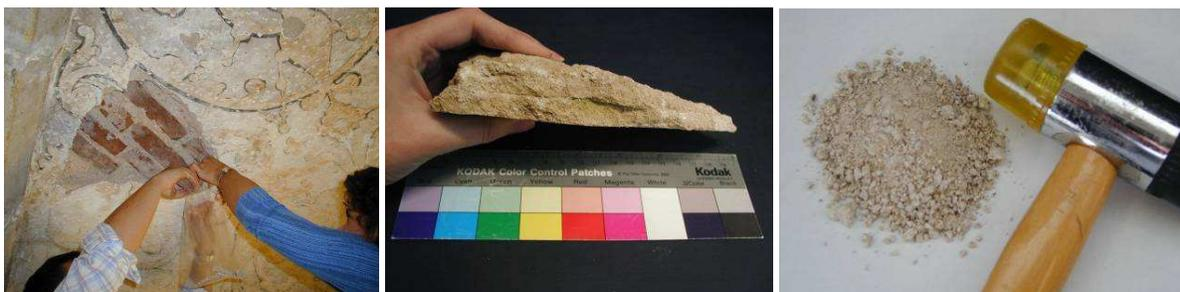
Figura 1 - Fotos tiradas durante a recolha de amostras, após limpeza e preparadas para ensaios.
