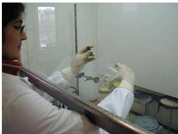
Figura 2 – Fotos tiradas durante a realização de alguns ensaios nomeadamente observação de uma amostra ao microscópio electrónico de varrimento (à esquerda) e realização do ataque ácido da amostra (à direita).
