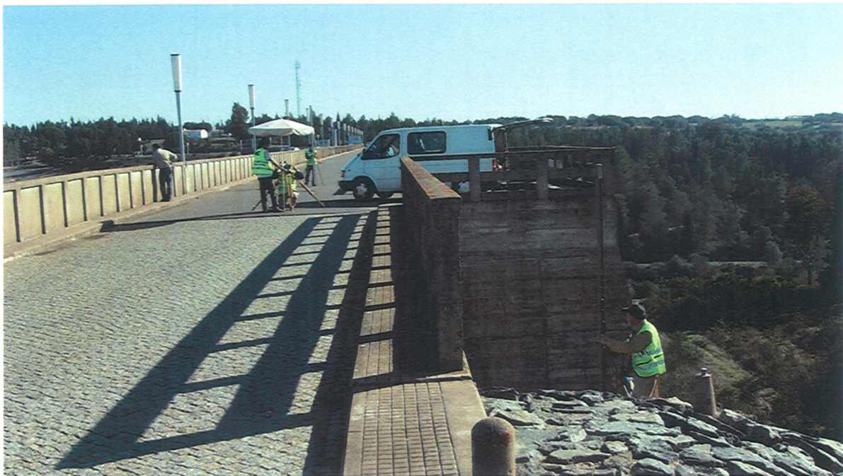
Figura 5 – Lanço muito desnivelado de uma linha de nivelamento. O operador visa a extremidade inferior de uma das miras e a extremidade superior da outra.
