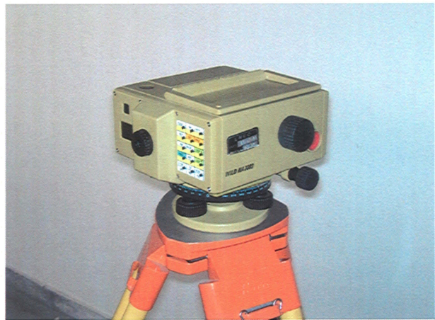
Figura 13 – Nível automático numérico Wild NA3003.
