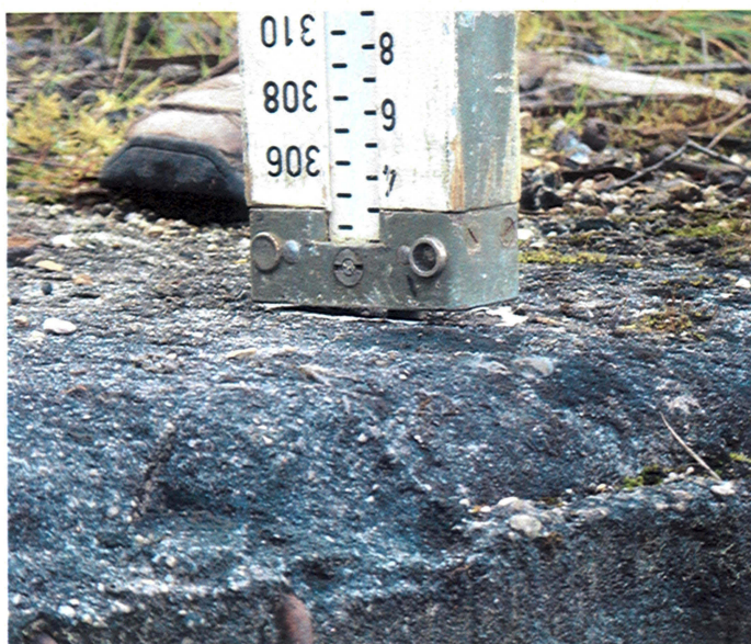
Figura 7 – Mira estacionada sobre a marca de nivelamento da Figura 8.
