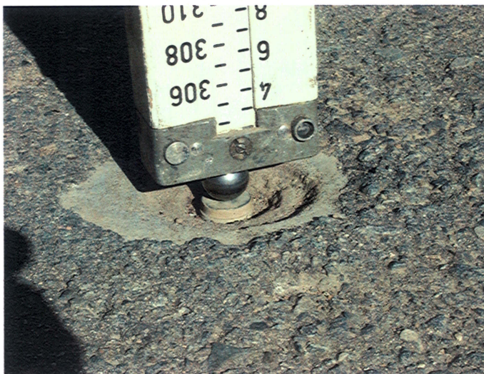
Figura 2 – Mira com escala invertida apoiada numa esfera de aço sobre o ponto objecto.
