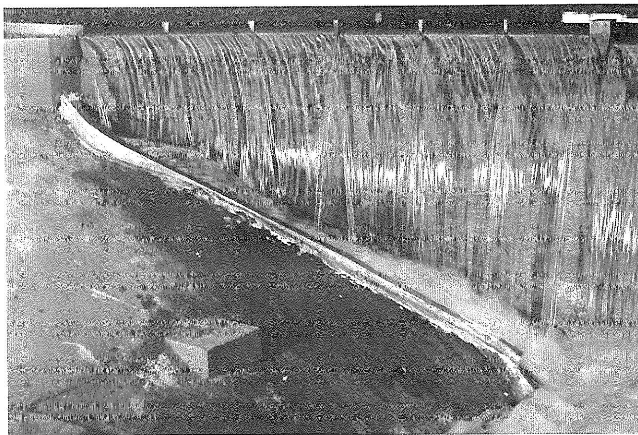
Fig III-6 — Aspectos do escoamento com a bacia projectada e com o caudal máximo (Tempo de exposição: 1/15 s em cima, 1/125 s em baixo)
