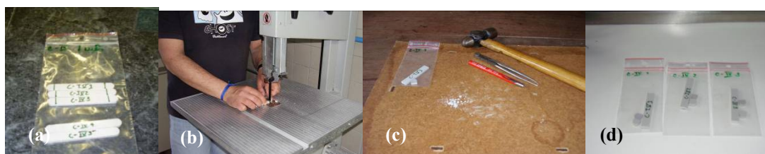
Figura 26: Preparação dos provetes: (a) marcação; (b) corte; (c) moagem; (d) condicionamento
