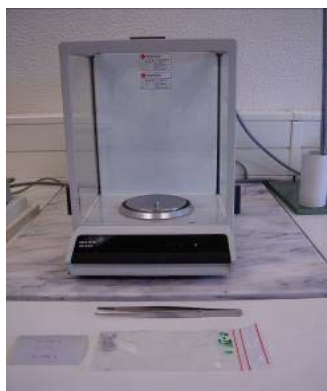
Figura 27: Pesagem dos cadinhos e da amostra
