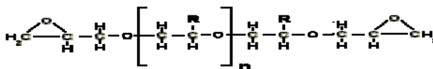
Figura 13: Molécula de uma resina flexível
